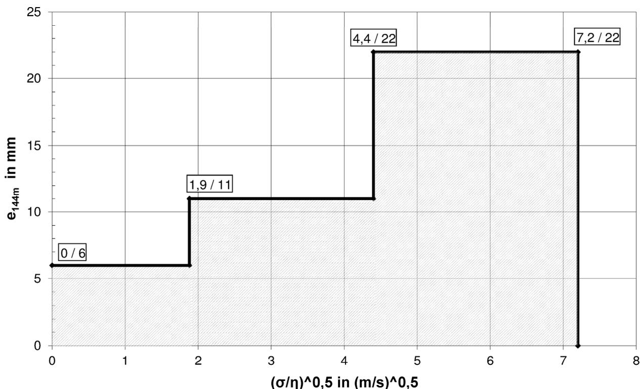
**Abbildung 1:** Eindringverhalten nicht betonangreifender Flüssigkeiten (mittlere Eindringtiefe  $e_{144m}$  von Flüssigkeiten)<sup>1) 2)</sup> aufgrund der jeweiligen dynamischen Viskosität  $\eta$  und Oberflächenspannung  $\sigma$
