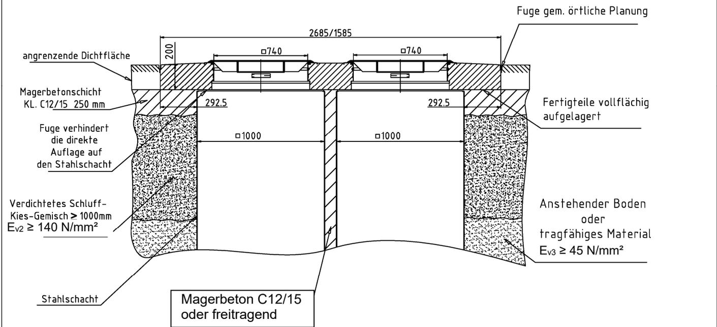
Abbildung 2: Ausbildung des Auflagers für Doppelkranzelemente
