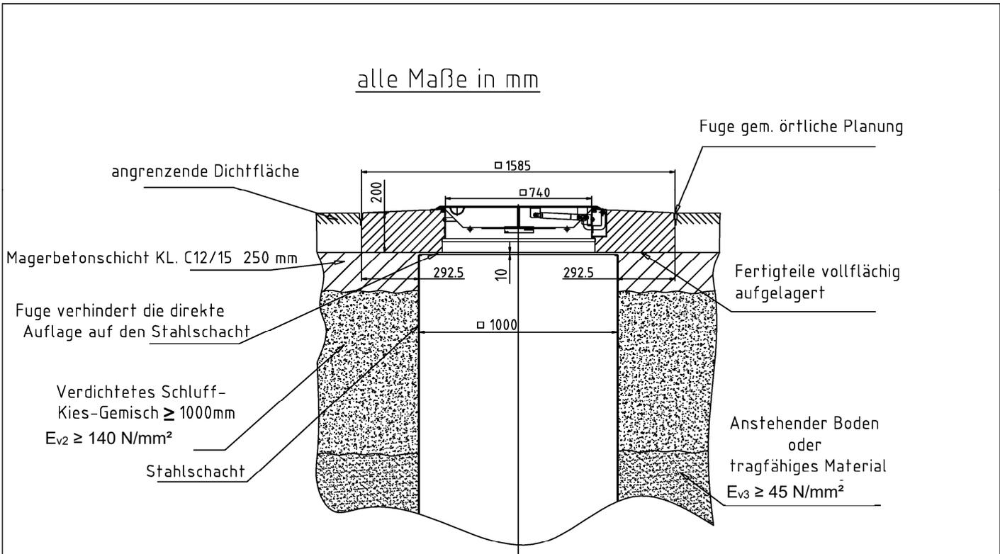
Abbildung 1: Ausbildung des Auflagers für Einzelkranzelemente
