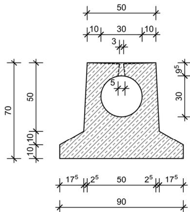
RIKI-CETON-SMART-Schlitzrinnensystem für die Verwendung in LAU-Anlagen
