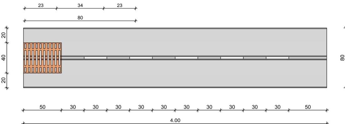
RIKI-CETON-SMART-Schlitzrinnensystem für die Verwendung in LAU-Anlagen
