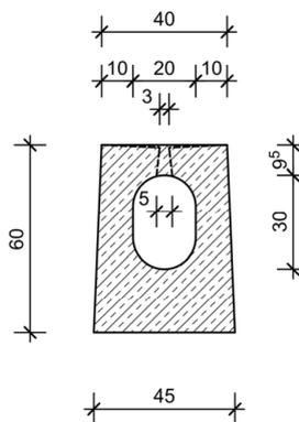
RIKI-CETON-SMART-Schlitzrinnensystem für die Verwendung in LAU-Anlagen
