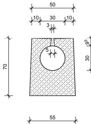
RIKI-CETON-SMART-Schlitzrinnensystem für die Verwendung in LAU-Anlagen
