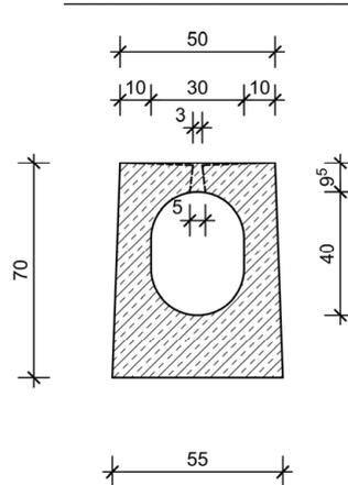
RIKI-CETON-SMART-Schlitzrinnensystem für die Verwendung in LAU-Anlagen
