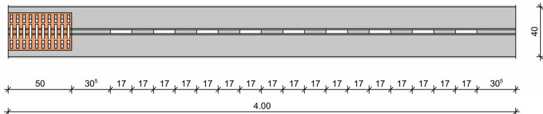
RIKI-CETON-SMART-Schlitzrinnensystem für die Verwendung in LAU-Anlagen
