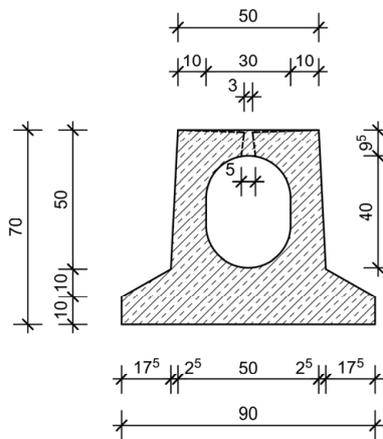
RIKI-CETON-SMART-Schlitzrinnensystem für die Verwendung in LAU-Anlagen
