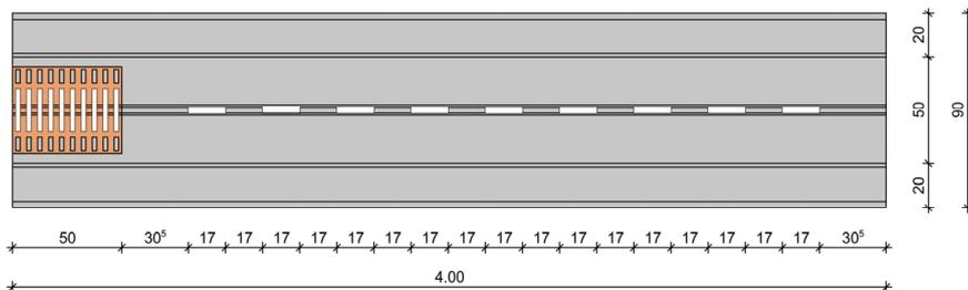
RIKI-CETON-SMART-Schlitzrinnensystem für die Verwendung in LAU-Anlagen
