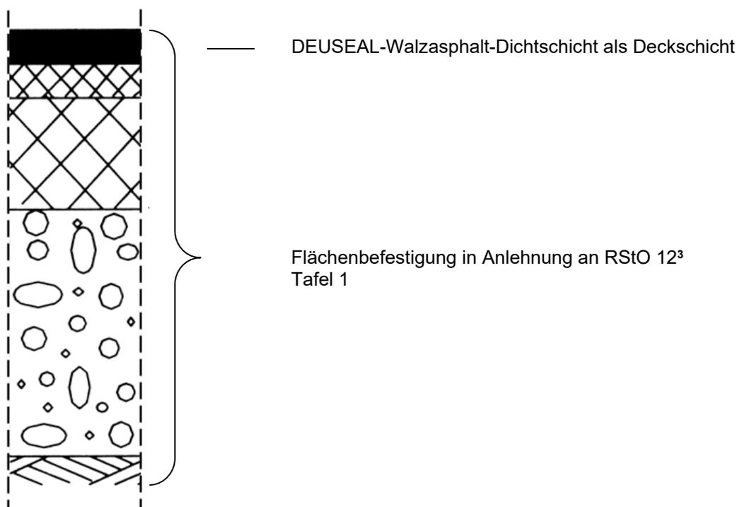
DEUSEAL-Walzasphalt-Dichtungsschicht zur Verwendung in L- und A-Anlagen von JGS-Anlagen und Biogasanlagen
