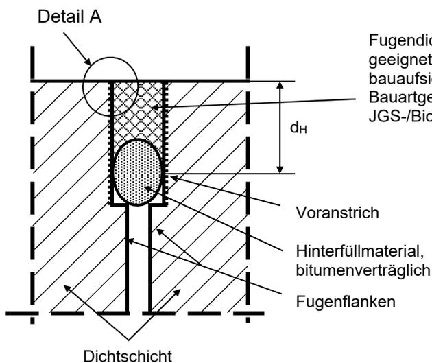
Fugendichtstoff bzw. Fugendichtmasse, der geeignet ist und über eine allgemeine bauaufsichtliche Zulassung/allgemeine Bauartgenehmigung für die Verwendung in JGS-/Biogasanlagen verfügt.
