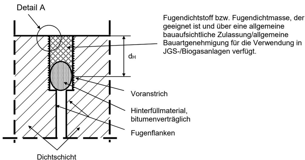
$d_H$  = Haft- bzw. Kontaktfläche des Fugendichtstoffes an der Fugenflanke. Dabei ist zu gewährleisten, dass die Fugenflanken parallel zueinander ausgeführt sind.
