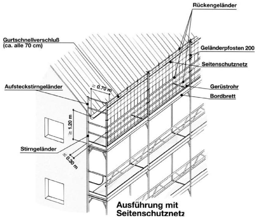
Regelausführung für das Gerüstsystem „Rahmengerüst FIX 70A“
