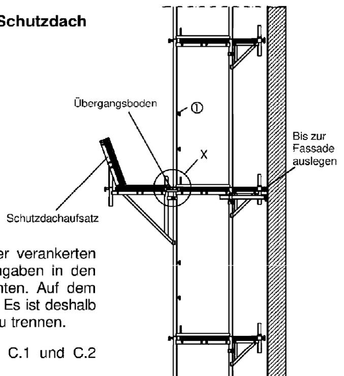
Das Schutzdach auf Konsole 74 kann in jeder verankerten Ebene angebracht werden. Dabei sind die Angaben in den Anlagen C9, C10 und C12 bis C15 zu beachten. Auf dem Schutzdach darf kein Material gelagert werden. Es ist deshalb durch einen Geländerholm ① vom Gerüstbelag zu trennen.
