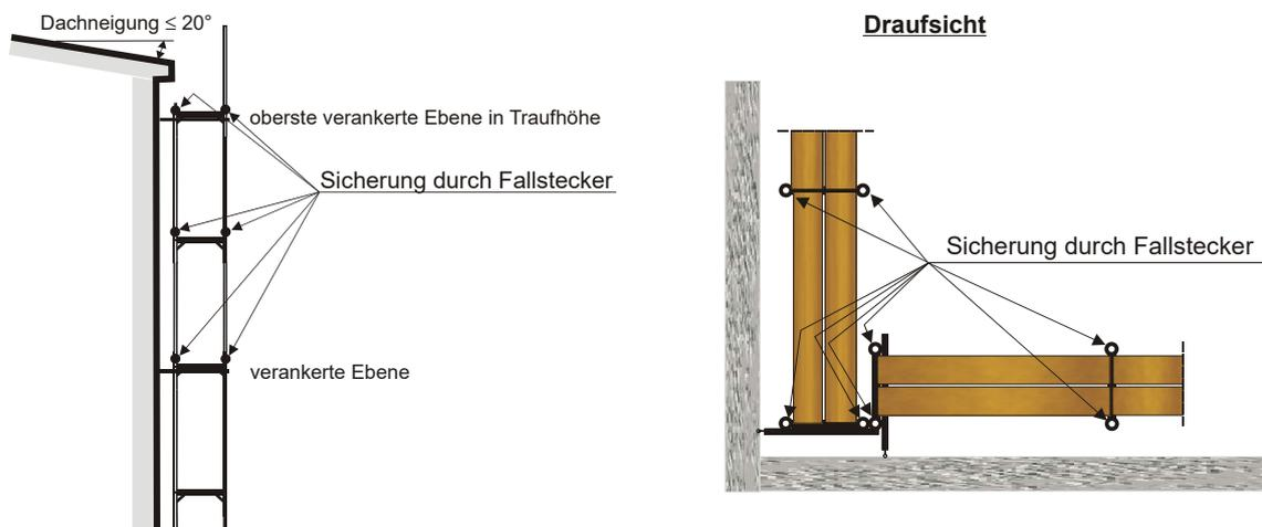
**Bild 1a:** Beispiel für die zugfeste Verbindung der Gerüστεbenen bei abhebenden Windkräften
