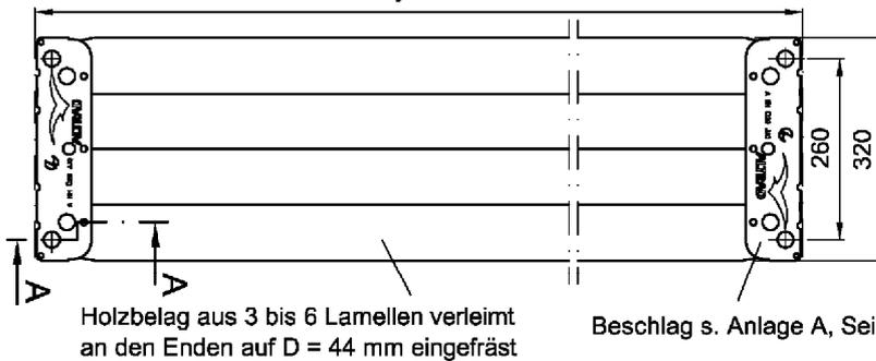
Holzbelag aus 3 bis 6 Lamellen verleimt an den Enden auf D = 44 mm eingefräst
