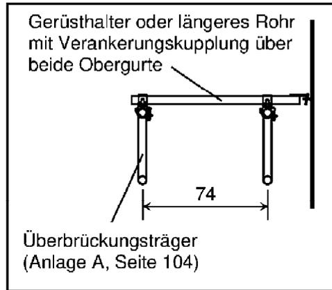
**Bild C.6:** Aussteifung der Überbrückungsträger mit Horizontalverband
