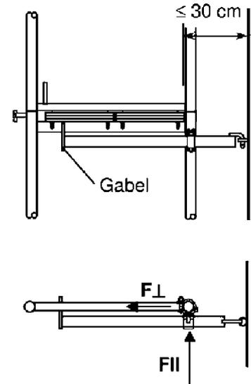
Gerüsthalter mit Gabel werden ebenfalls nur am Innenstiel befestigt. Die Gabel umfasst den Auflagerriegel des Vertikalrahmens von unten. Der Einsatz ist nur bei der Grundvariante vorgesehen. Dabei ist jeder Anker als Gerüsthalter mit Gabel auszuführen. (siehe Anlage B, Abschnitt B.5).
