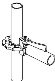
**Bild C.3:** Keilschloss-Verbindung
