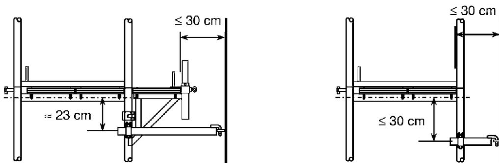
**Bild C.1b:** Höhenlage der Gerüsthalter bei versetztem Anschluss.
