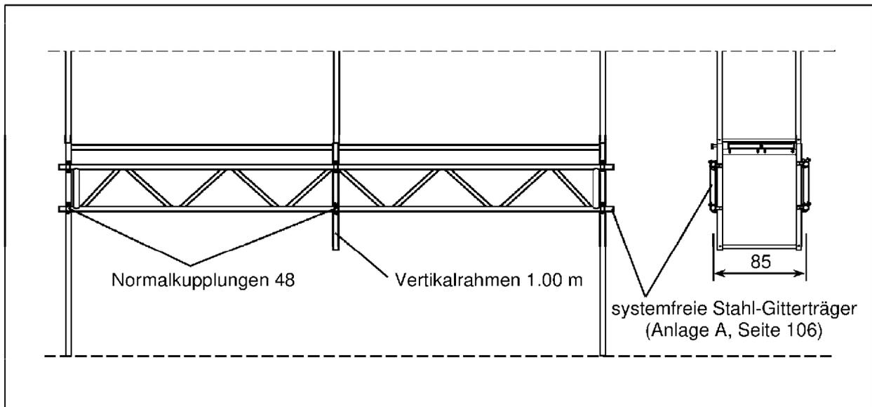
Verankerung und Aussteifung der systemfreien Gitterträger wie Überbrückungsträger.
