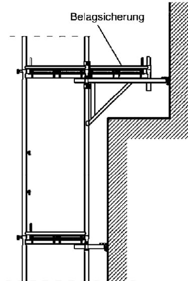
Die Konsolen 64 und 74 dürfen je für sich in einer beliebigen Ebene angeordnet werden. In der Konsolebene ist jeder Rahmen zu verankern. Bei  $L = 3.00$  m sind auch in der Ebene darunter mindestens „kurze“ Anker nach Bild C.1 anzubringen (siehe auch Anlage C9 bis C11). Die Verankerungskräfte können der Tabelle C.1 entnommen werden.
