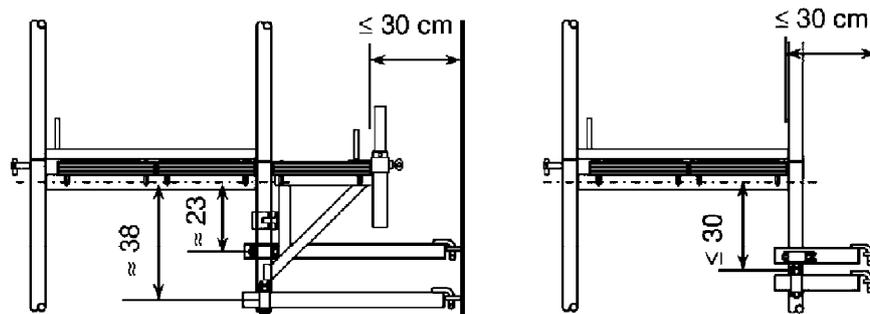
Dreieckhalter werden nur am fassadenseitigen Ständerrohr befestigt. Sie nehmen Ankerkräfte rechtwinklig und parallel zur Fassade auf. Ohne weitere statische Nachweise dürfen die Dreieckhalter bei den nachgewiesenen Aufstellvarianten gemäß der Darstellung in Bild C.2b nach unten versetzt werden. Eine Ausnahme bildet das Gerüst mit Planenbekleidung (siehe Anlage C, Seite 19).
