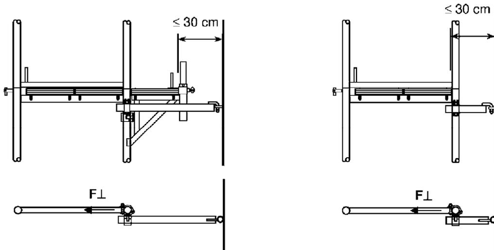
**Bild C.1a:** Höhenlage der Gerüsthalter bei Anschluss im „Knoten“.
