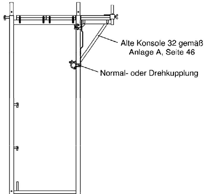
Damit Gerüst- und Konsolbelag auf einer Höhe liegen, muss bei den alten Verbreiterungskonsolen 32 mit Blechanlage gemäß Anlage A, Seite 46 die Anschlusskupplung unter den Auflagerriegel des Vertikalrahmens anschlagen. Bei Verwendung von Rahmen mit 4-kant Einpressung des Rohrverbinders kann die Kupplung unter Umständen abrutschen. Es ist deshalb eine zusätzliche Rutschsicherung erforderlich, z.B. das Anbringen einer Normal- oder Drehkupplung unter dem Anlageblech.
