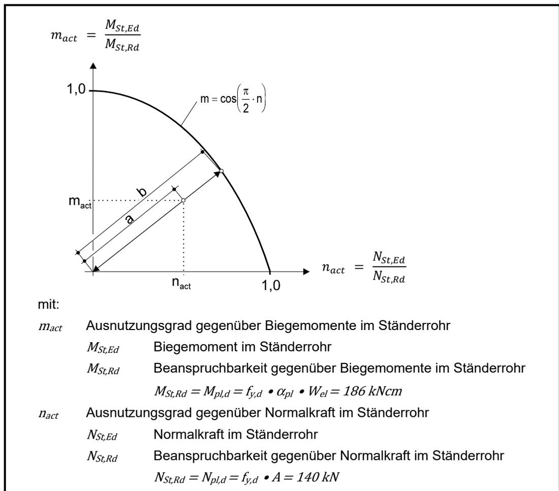
**Bild 1:** Vektorel Ausnutzungsgrad im Ständerrohr
