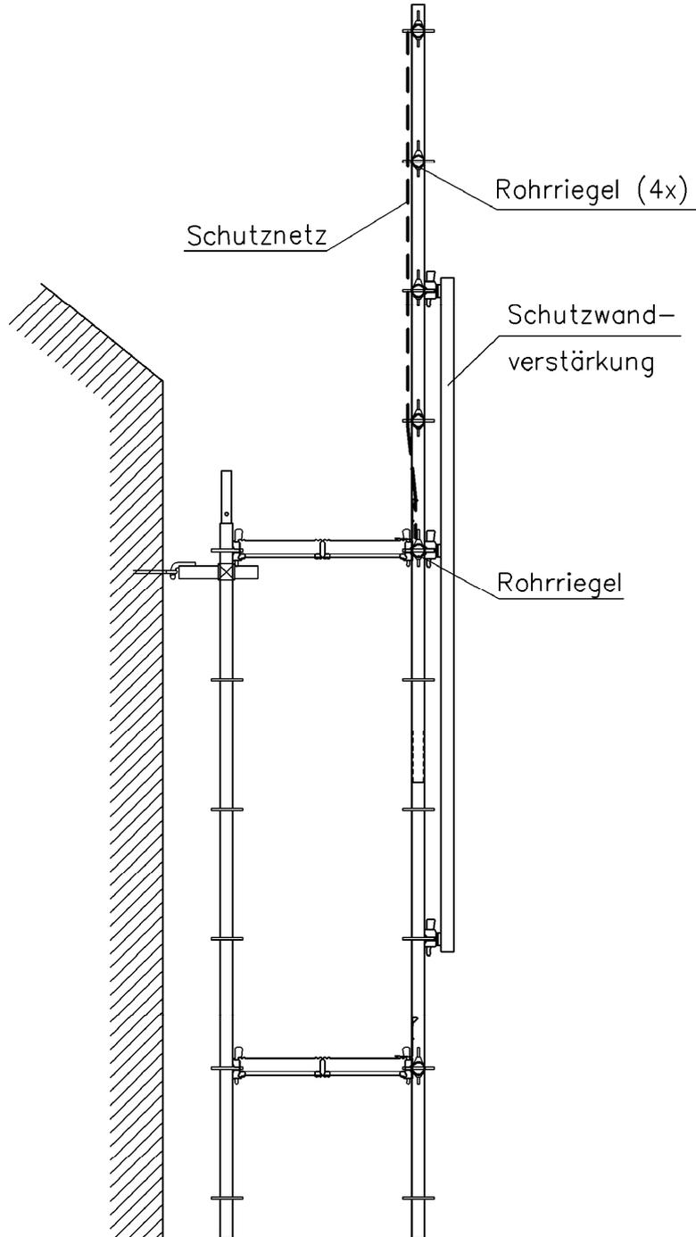
Schutznetz: DIN EN 1263-1, Maschenweite 100 mm; Seildicke 5 mm
