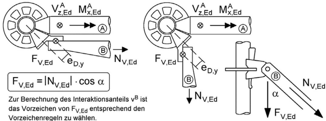
**Bild 2:** Situation zur Ermittlung der Querkraftauslastung
