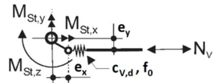
Die folgenden Knotenmomente in Abhängigkeit der Diagonalenausführung müssen vom Ständer und den Riegeln aufgenommen werden.
