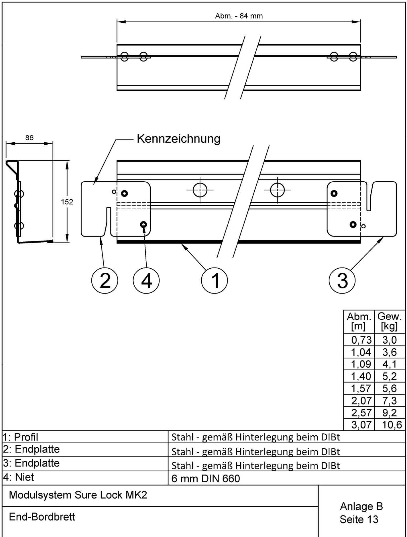
Verwendung für Gerüst bis Lastklasse 4 (3,07m) / 5 (2,57m) / 6 (0,73/1,09/1,57/2,07m)
