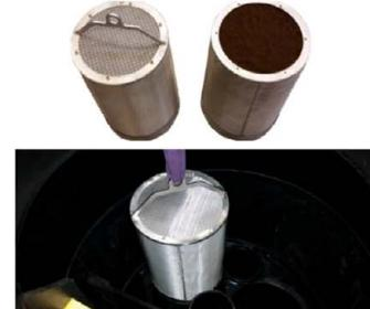
12. Die Substratkartuschen sind zu öffnen (Abschrauben der Flügelschrauben am Deckel) und das Ferrosorp Plus Substrat in die Kartusche einzufüllen (30 kg je Kartusche, 2 Säcke à 15 kg). Nach dem Schließen der Substratkartusche ist die Dichtung zu kontrollieren und die Kartuschen in den Certaro DN 1000 Substrat einzusetzen.
