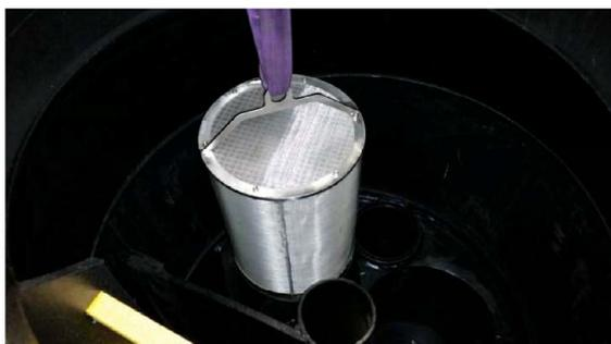
Bild 4: Herausheben der Substratkartusche
