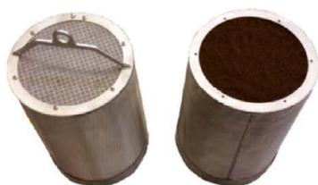
Bild 2: Substratkartusche mit und ohne Deckel
