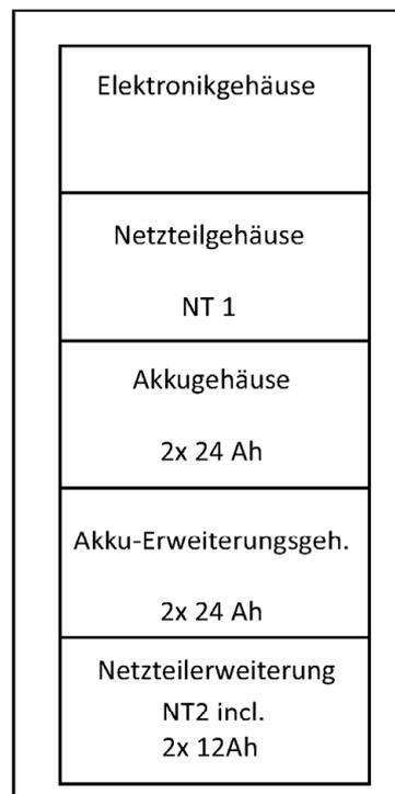
Verteiler für Brandmeldeanlagen mit einem Funktionserhalt von 30 Minuten im Brandfall
