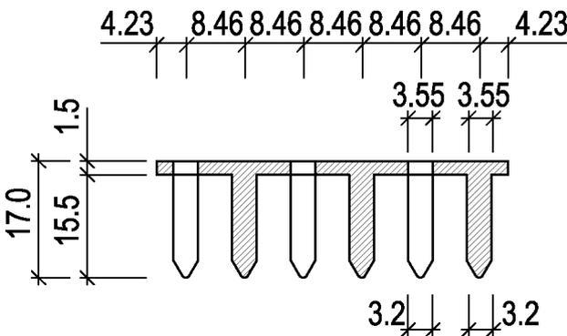
Tragende Holzverbindungen unter Verwendung von Wolf-Nagelplatten
