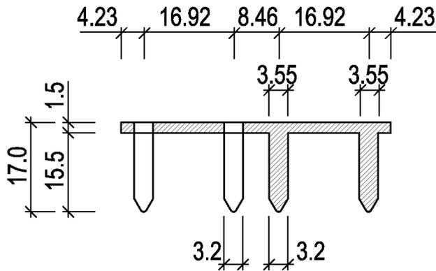
Tragende Holzverbindungen unter Verwendung von Wolf-Nagelplatten
