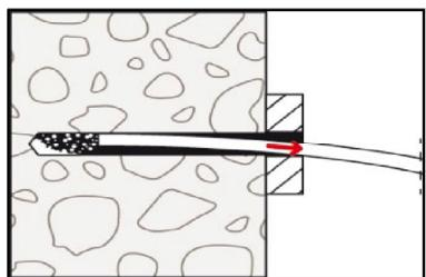
2. Base material group „a“, „b“, „d“: Remove dust from borehole.
