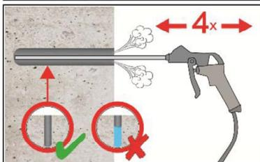
2c. Abschließend Bohrloch mindestens 4x mit Druckluft (min. 6 bar) (Anhang B 5) über die gesamte Verankerungstiefe (ggf. Verlängerung verwenden) ausblasen, bis die ausströmende Luft staubfrei ist.
