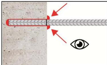
10. Ringspalt zwischen Bewehrungsstab und Verankerungsgrund muss vollständig mit Mörtel gefüllt sein. Andernfalls Anwendung vor Erreichen der maximalen Verarbeitungszeit  $t_{work}$  ab Schritt 8 wiederholen.
