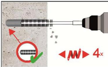
2b. Bohrloch mindestens 4x mit Bürste RBT gemäß Tabelle B3 drehend über die gesamte Verankerungstiefe (ggf. Bürstenverlängerung RBL verwenden) ausbürsten.
