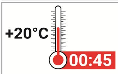
12. Temperaturabhängige Aushärtezeit  $t_{cure}$  (Anhang B 6) muss eingehalten werden. Die volle Belastung darf erst nach Erreichen der vollen Aushärtezeit  $t_{cure}$  erfolgen.
