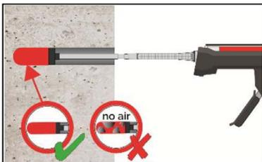
8b. **Injizieren mit Verfüllstutzen VS:**
