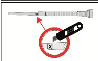
3a. Bei Verwendung der Mischerverlängerung VL16/1,8, muss die Spitze des Mixers PM-19E an der Position „X“ abgeschnitten werden .
