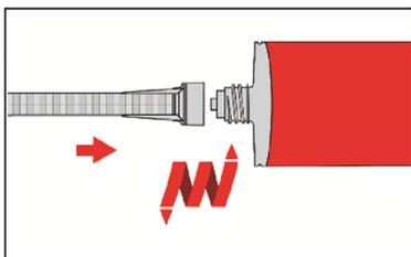
3. Statikmischer SM-14W oder PM-19E, aufschrauben und Kartusche in geeignetes Auspressgerät einlegen. Den Schlauchfolienclip vor der Verwendung abschneiden. Bei Arbeitsunterbrechungen, länger als die maximale Verarbeitungszeit  $t_{work}$  (Anhang B 6) und bei neuen Kartuschen, neuen Statikmischer verwenden.
