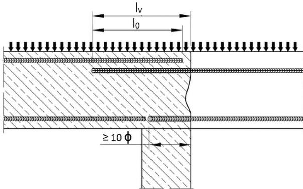
**Bild A2:** Übergreifungsstoß einer biegebeanspruchten Stütze oder Wand an ein Fundament
