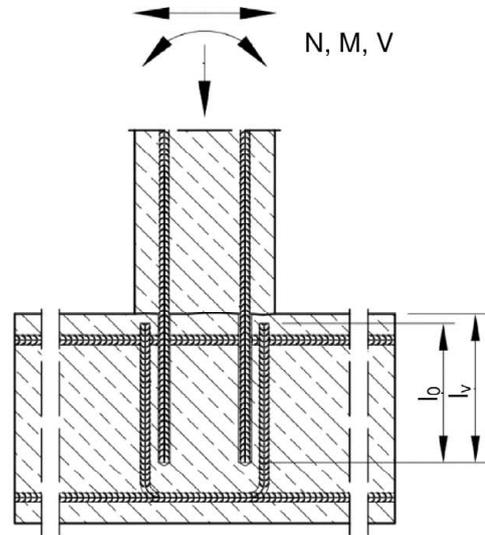
**Bild A3:** Endverankerung von Platten oder Balken (z.B. gelenkig gelagert bemessen)
