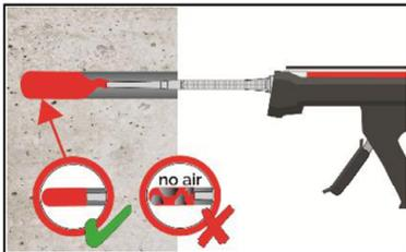
8a. **Injizieren ohne Verfüllstutzen VS:**
