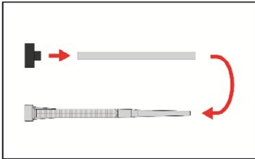
7. Verfüllstutzen VS und Mischerverlängerung VL sind gem. Tabelle B3 verwenden
