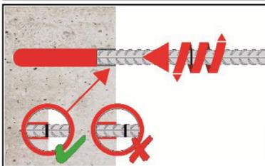
9. Bewehrungsstab mit leichter Drehbewegung bis zur Markierung einführen.
