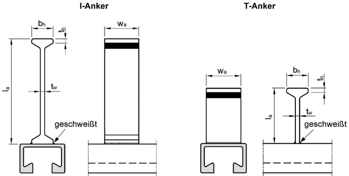
Verfügbare Konfigurationen (Ankertyp, Orientierung von Anker und Schweißung): siehe Anhang A9, A10 und A11
