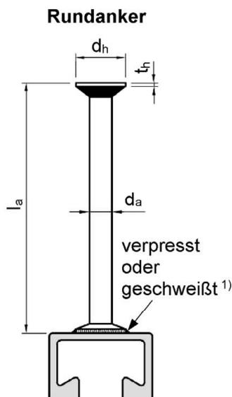
1) Nur Ankerschiene JTA: geschweißter Anker
