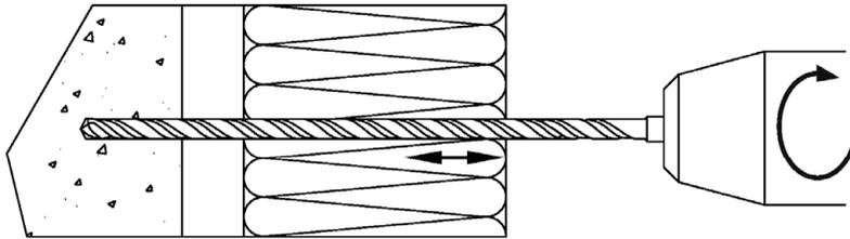
1) Bohrloch senkrecht zur Oberfläche erstellen. Reinigung des Bohrlochs.
