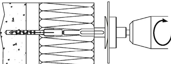
4) Dübel mit Schraubgerät bis die Anschlagsscheibe auf dem Dämmstoff anliegt einschrauben.
