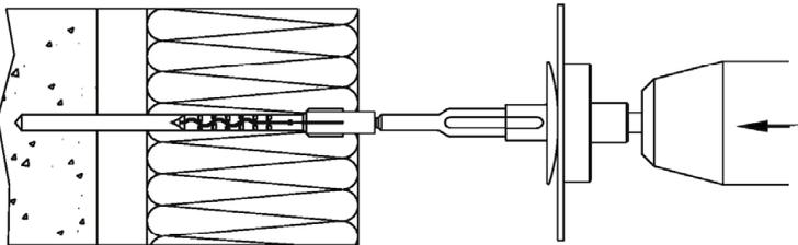
3) Dübel in das Bohrloch durch den Dämmstoff bis zur Schaftvergrößerung des Haltetellers einsetzen.
