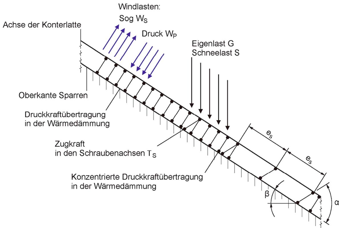
Abbildung A.3.1 Befestigung von Aufdach-Dämmsystemen auf Sparren – Statisches Modell für parallel angeordnete Schrauben
