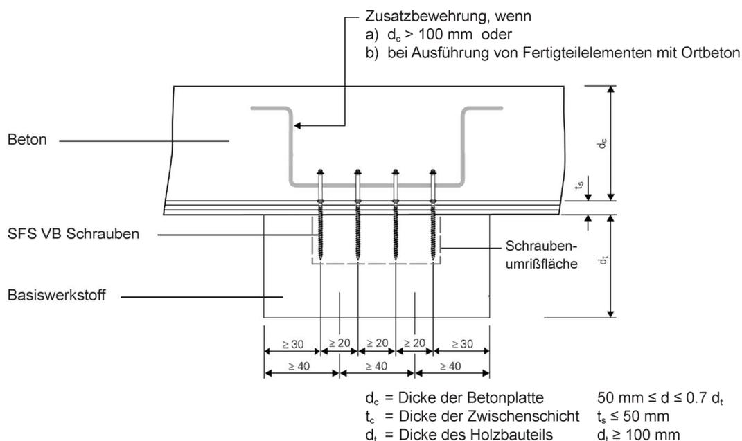
Abbildung A.2.2 Querschnitt einer Holz-Beton-Verbundkonstruktion mit SFS VB Schrauben
