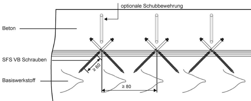
Abbildung A.2.1 Prinzipielle Ansicht einer Holz-Beton-Verbundkonstruktion mit SFS VB Schrauben
