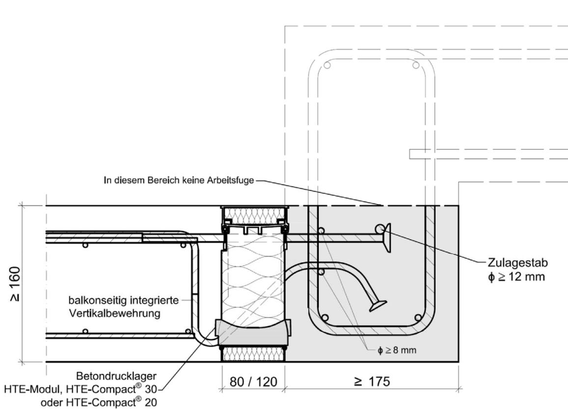
Abb. B.11: Beispiel für Schöck Isokorb® Typ K-U mit CCE in eingebautem Zustand mit Anschluss an Wand oder Höhenversatz
