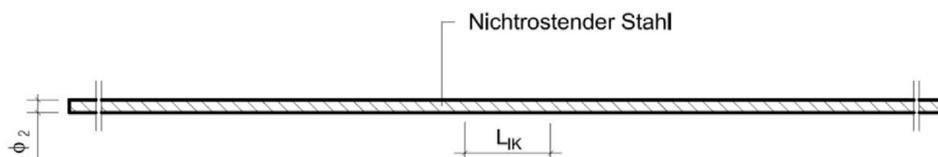
Abb. A.39: Druckelement aus nichtrostendem Betonstahl
