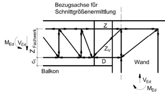
Abb. D.6: Schöck Isokorb® Typ K-O und K-O-F mit Anschluss an Wand
