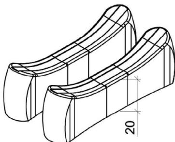
Abb. A.42: Druckelement aus Beton
