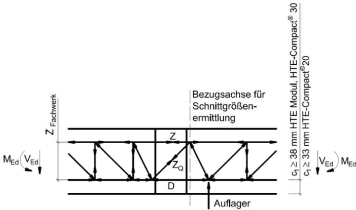
Abb. D.1: Schöck Isokorb® Typ K, K-F (Variante mehrteilig) mit Druckelementen aus Beton
