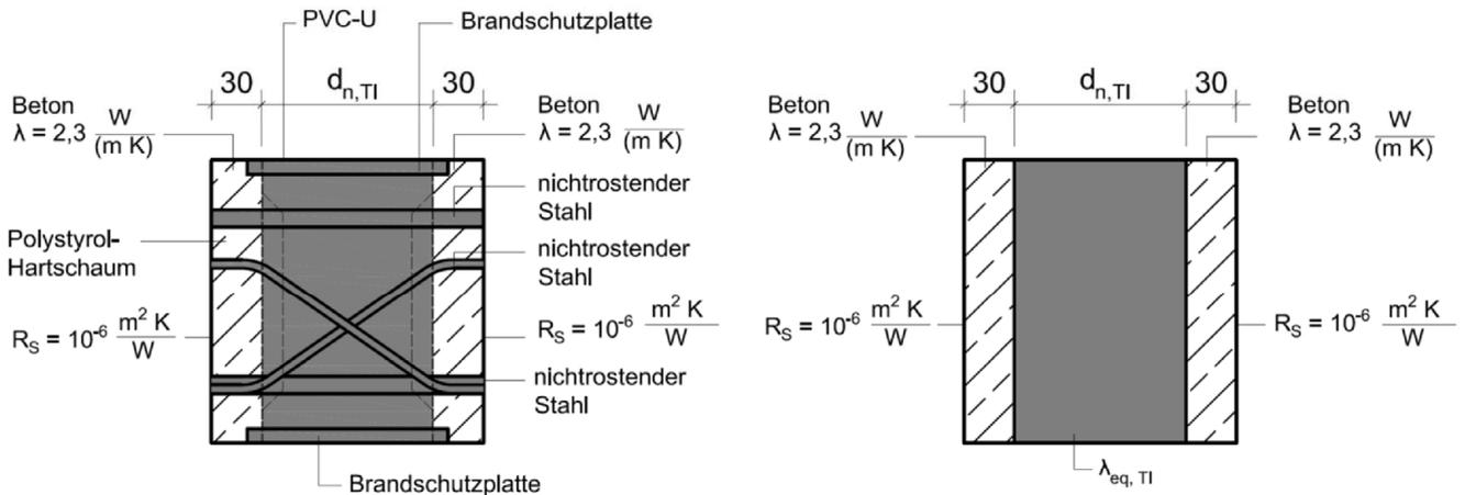
Abb. C.8: Querschnitt der Konstruktion mit Druckelementen aus Stahl (SCE) zur Bestimmung des äquivalenten Wärmedurchlasswiderstandes  $R_{eq, TI}$  sowie vereinfachtes Modell mit  $\lambda_{eq, TI}$
