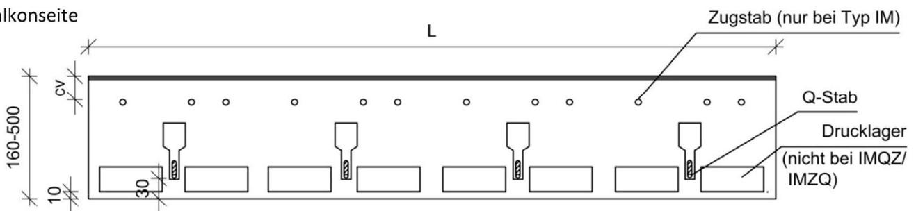
Plattenanschluss ISOPRO IP und ISOMAXX IM
