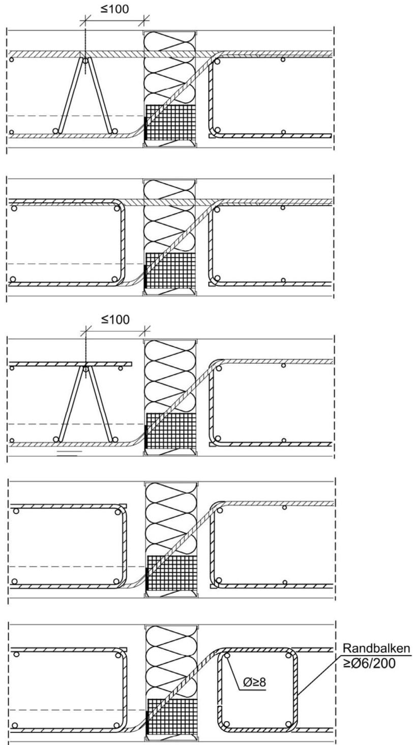
Plattenanschluss ISOPRO IP und ISOMAXX IM
