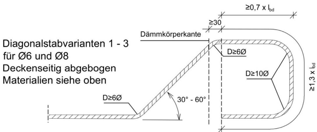
Plattenanschluss ISOPRO IP und ISOMAXX IM
