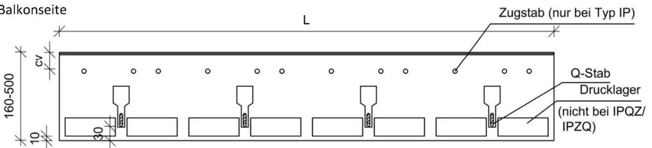
Plattenanschluss ISOPRO IP und ISOMAXX IM
