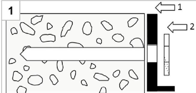
1 Nach Bohrlochherstellung (Anhang B5), zuerst das Anbauteil (1), dann die Verfüllscheibe (2) positionieren
