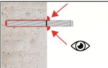
9. Ringspalt zwischen Ankerstange und Verankerungsgrund muss vollständig mit Mörtel gefüllt sein. Bei Durchsteckmontage muss auch der Ringspalt im Anbauteil mit Mörtel verfüllt sein. Andernfalls Anwendung vor Erreichen der maximalen Verarbeitungszeit  $t_{work}$  ab Schritt 7 wiederholen.
