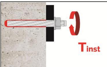
12. Anbauteil mit kalibriertem Drehmomentschlüssel montieren. Maximales Montagedrehmoment (Tabelle B1 oder B3) beachten. Bei statischer Vorgabe (z.B. Erdbeben), Ringspalt im Anbauteil mit Mörtel gemäß Anlage A 2 verfüllen. Dazu Unterlegscheibe durch Verfüllscheibe VFS ersetzen und Mischerreduzierung MR verwenden.
