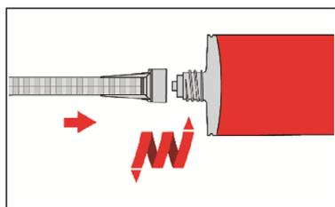
3. Statkmischer PM-19E, aufschrauben und Kartusche in geeignetes Auspressgerät einlegen.
