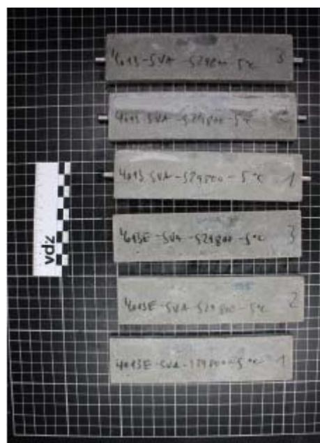
**Bild A2:** Probekörper mit CEM III/B 42,5 L-LH/SR nach der Sulfatlagerung;
