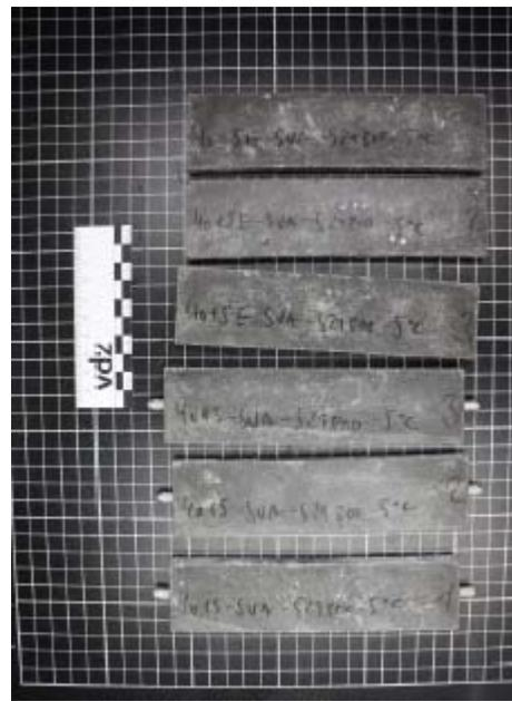
**Bild A3:** Probekörper mit CEM I 42,5 R-SR0 nach der Sulfatlagerung;
