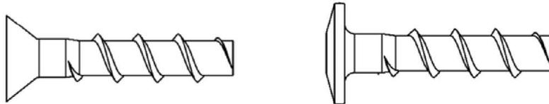
z.B. TOGE Isolierschraube TIS, Ausführung mit Linsenkopf und Anbauteil
