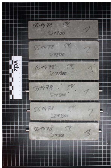
Bild A2: Probekörper mit CEM III/B 32,5 N-LH/SR nach der Sulfatlagerung; Links: nach 182 Tagen bei 20 °C; Rechts: nach 91 Tagen bei 5 °C
