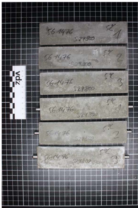
Bild A1: Probekörper mit CEM III/A 32,5 N-LH/SR/LA "Lägerdorf" nach der Sulfatlagerung; Links: nach 182 Tagen bei 20 °C; Rechts: nach 91 Tagen bei 5 °C
