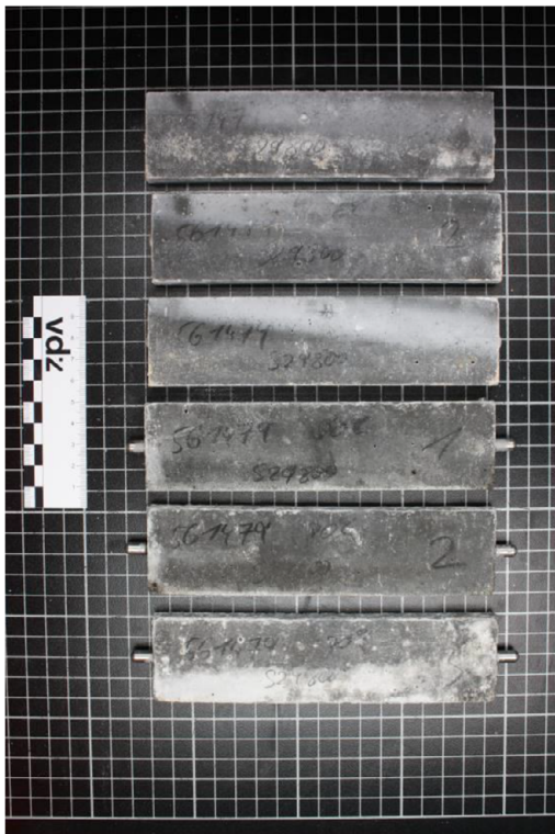
Bild A3: Probekörper mit CEM I 42,5 R-SR3 nach der Sulfatlagerung; Links nach 182 Tagen bei 20 °C; Rechts: nach 91 Tagen bei 5 °C
