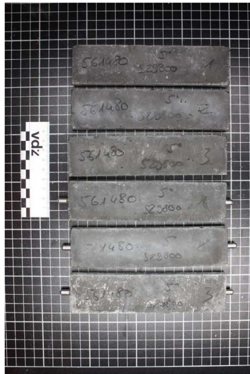
Bild A3: Probekörper mit CEM I 42,5 R-SR3 nach der Sulfatlagerung; Links nach 182 Tagen bei 20 °C; Rechts: nach 91 Tagen bei 5 °C
