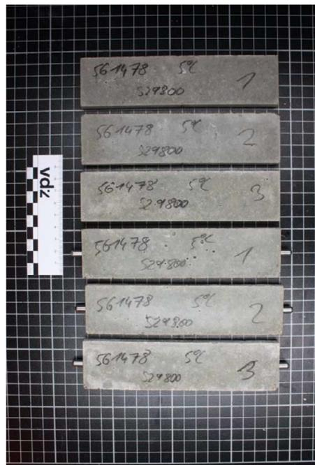
**Bild A2:** Probekörper mit CEM III/B 32,5 N-LH/SR nach der Sulfatlagerung;
