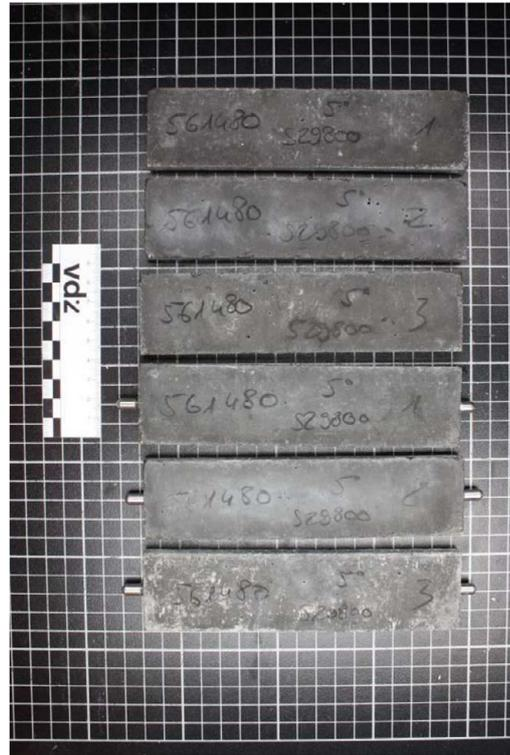
**Bild A3:** Probekörper mit CEM I 42,5 R-SR3 nach der Sulfatlagerung;
