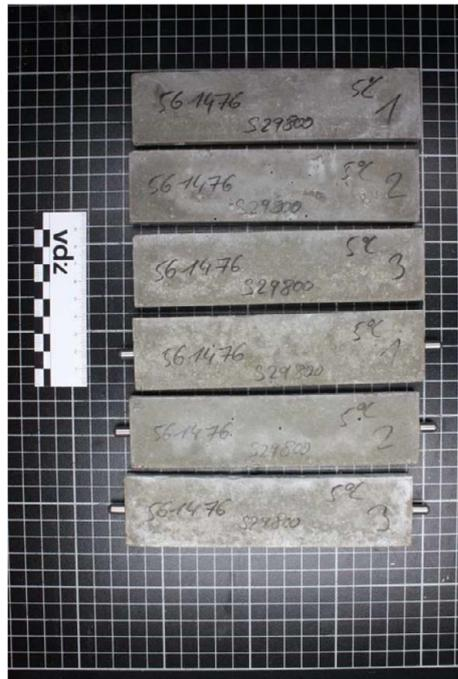
**Bild A1:** Probekörper mit CEM III/A 32,5 N-LH/SR/LA "Lägerdorf" nach der Sulfatlagerung;
