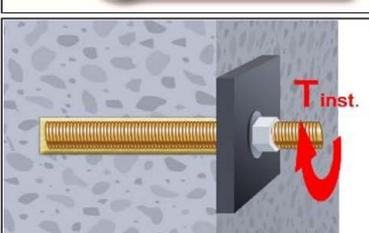
12. Anbauteil mit kalibriertem Drehmomentschlüssel montieren. Maximales Montagedrehmoment (Tabelle B1) beachten.
