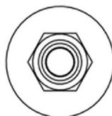
Ausführung mit Innengewinde und Sechskantantrieb z.B. TAPCON XTREM LT A4 6x55 IM M8/10; Typ I
