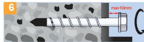
Die Schraube darf max 10mm gelöst werden
