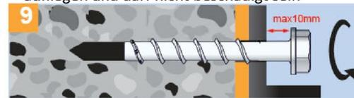
Die Schraube darf max 10mm gelöst werden
