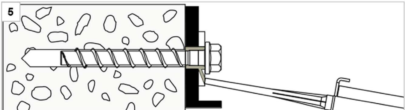
5 Verfüllung des Ringspalts mit chemischem Mörtel
