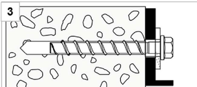
3 Einbauzustand ohne verfüllten Ringspalt
