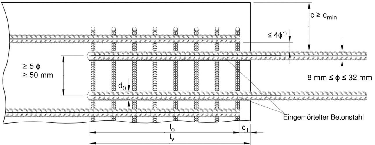
1) Ist der lichte Abstand der gestoßenen Stäbe größer als  $4\phi$ , so muss die Übergreifungslänge um die Differenz zwischen dem vorhandenen lichten Stababstand und  $4\phi$  vergrößert werden.
