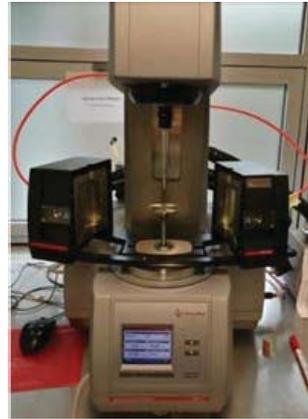
**Abb. A 5.1:** Versuchsaufbau, Rheometer
