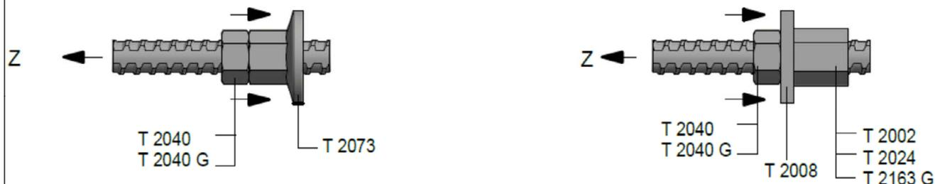
Bild 9: GEWI® - Verankerung bei Druckbeanspruchung
