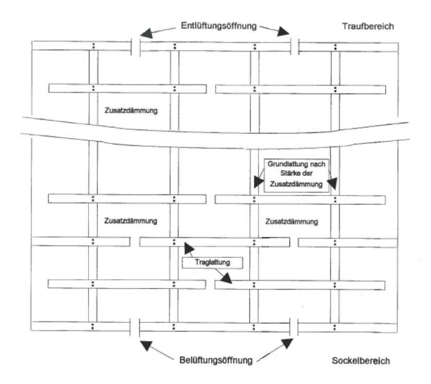
Die Befestigung der INTE-ROBA Aluminium-Fassadenpaneele darf auch ohne Grundlatten erfolgen, wenn keine Zusatzdämmung vorhanden ist.
