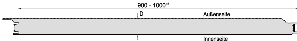
$t_{nom1}$ : Nennblechdicke, äußere Deckschicht  $t_{nom1}$ : 0,50 ; 0,63 ; 0,75 ; 0,88 ; 1,00 mm
