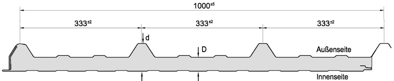
$t_{nom1}$ : Nennblechdicke, äußere Deckschicht  $t_{nom1}$ : 0,50 ; 0,63 ; 0,75 ; 0,88 ; 1,00 mm
