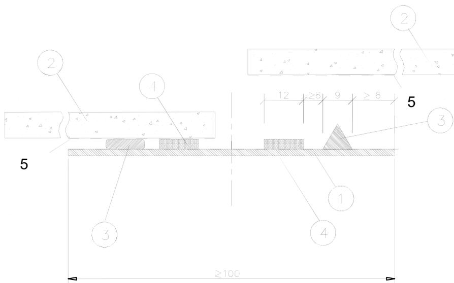
2. Klebeverbindung im Plattenmittelfeld und auf Endprofilen
