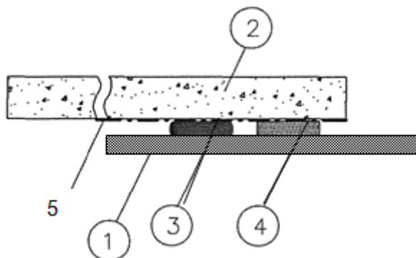
Fassadensystem unter Verwendung des Klebesystems "Innotec Project System" zur Befestigung von hinterlüfteten Fassadenplatten auf einer Aluminium-Unterkonstruktion
