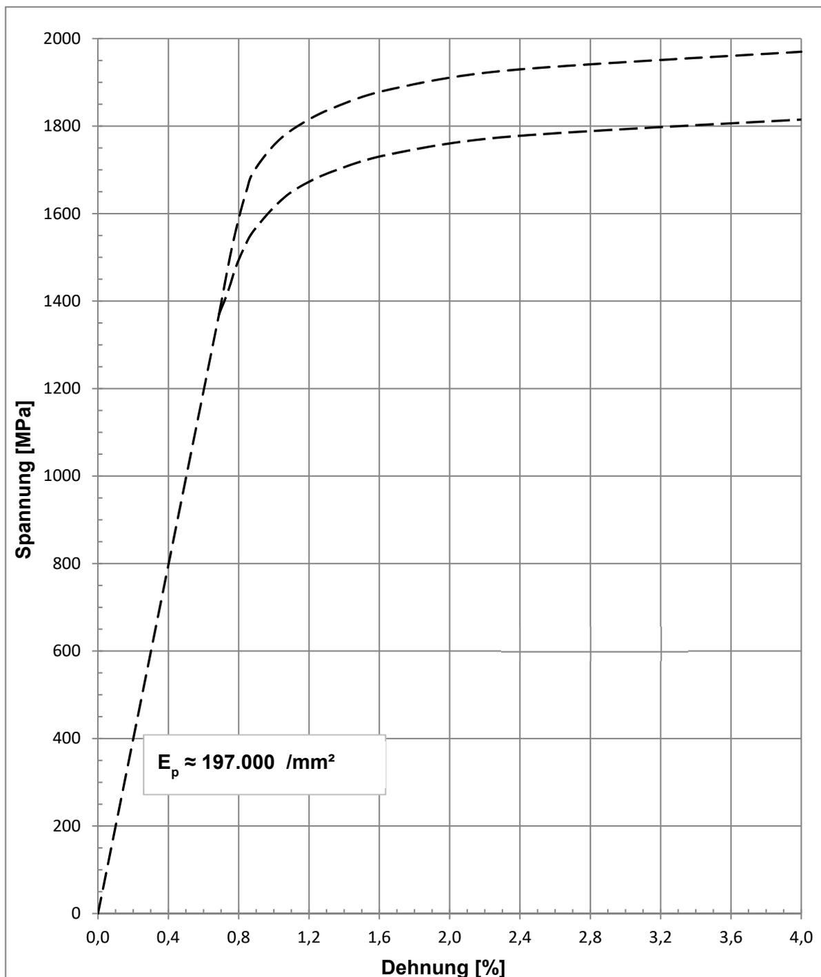
Die Linien geben eine Orientierung für den prinzipiellen Spannungs-Dehnungs-Verlauf bei Annahme des Rechenwertes des E-Moduls ( $E_p$ ) von 197.000 N/mm<sup>2</sup>.
