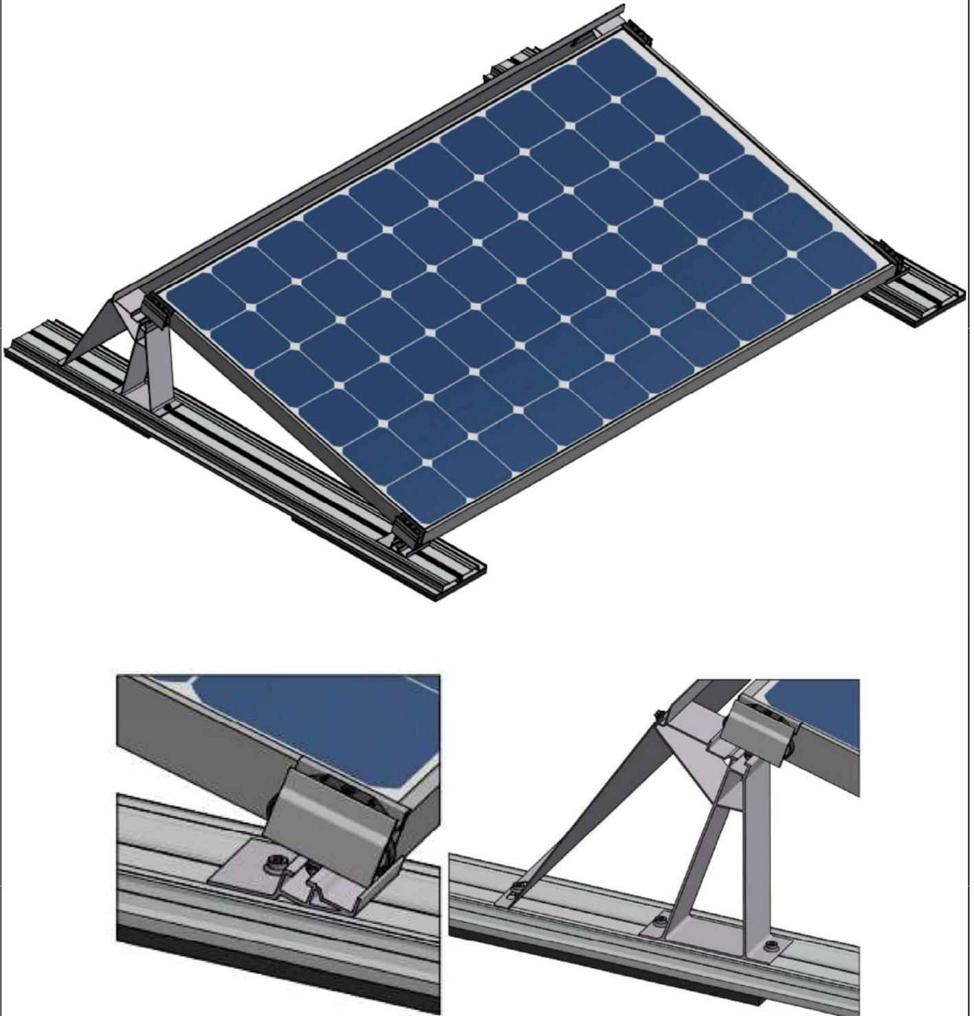
Aufständer-/Montagesysteme "AeroFix"/"AeroFix G3", "AeroFlat"/"AeroFlat G3" und "TopFix 200" zur Befestigung und Aufständerung von Photovoltaik-Modulen
