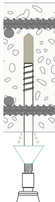
TOGE TSM BC SB reLAST für die Querkraftverstärkung
