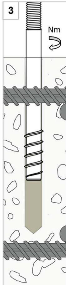
Schraube mit Schlagschrauber (600 Nm bis 1000 Nm) setzen
