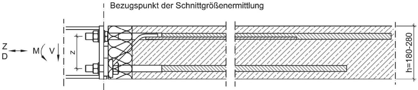
Abbildung 45: Seitenansicht IP 80 SM20 Q10 und IP 80 SM20 Q12
