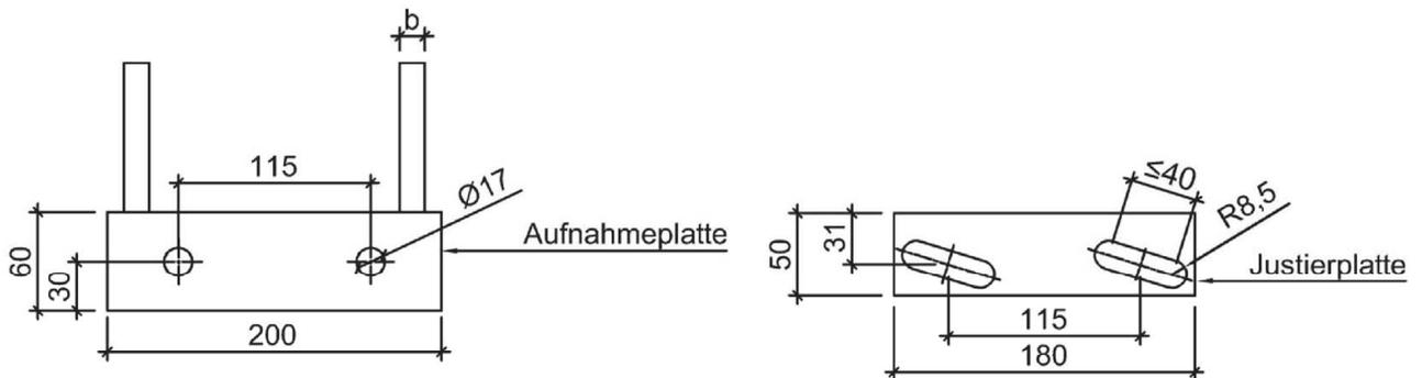
Abbildung 28: Detail Aufnahme- und Justierplatte
