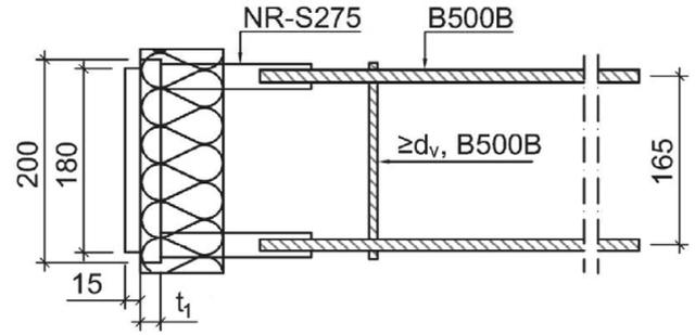
Abbildung 23: Querkraftelemente
