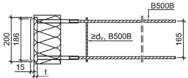
Abbildung 35: Querkraftelemente
