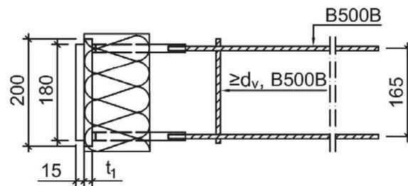
Abbildung 39: Querkraftelement
