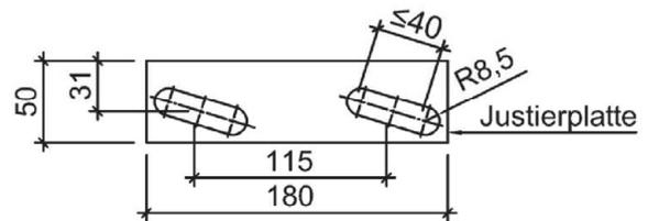
Abbildung 40: Detail Aufnahme- und Justierplatte
