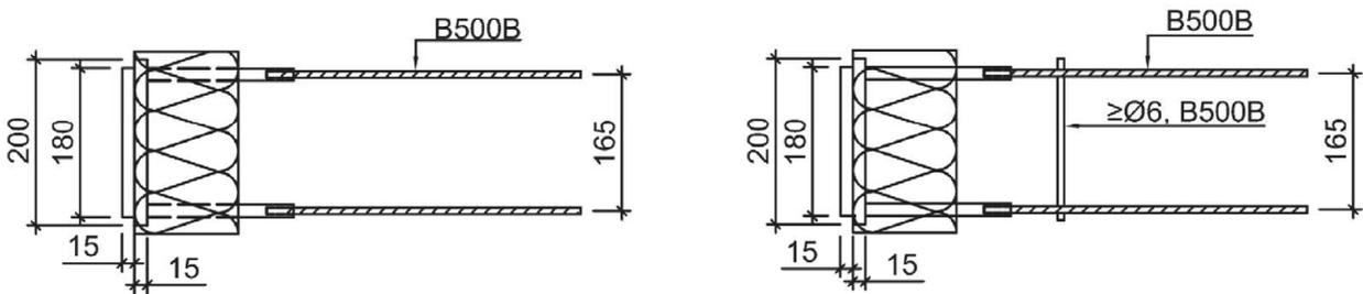
Abbildung 27: Querkraftelemente
