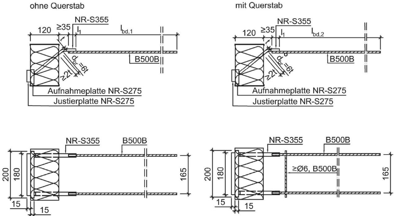
Abbildung 31: Querkraftelemente
