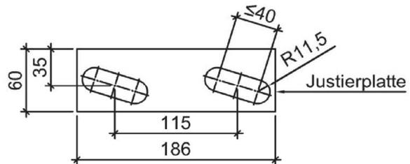
Abbildung 36: Detail Aufnahme- und Justierplatte
