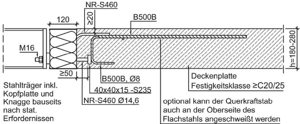
**Abbildung 37:** Seitenansicht IP 120 SQ8, IP 120 SQ10 und IP 120 SQ12
