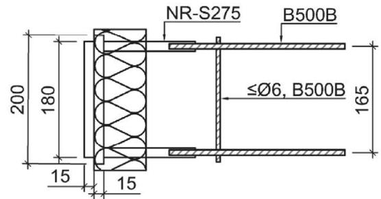
Abbildung 11: Querkraftelemente
