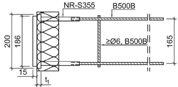
Abbildung 19: Querkraftelemente
