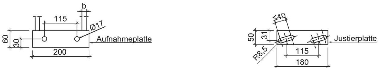
Abbildung 16: Detail Aufnahme- und Justierplatte
