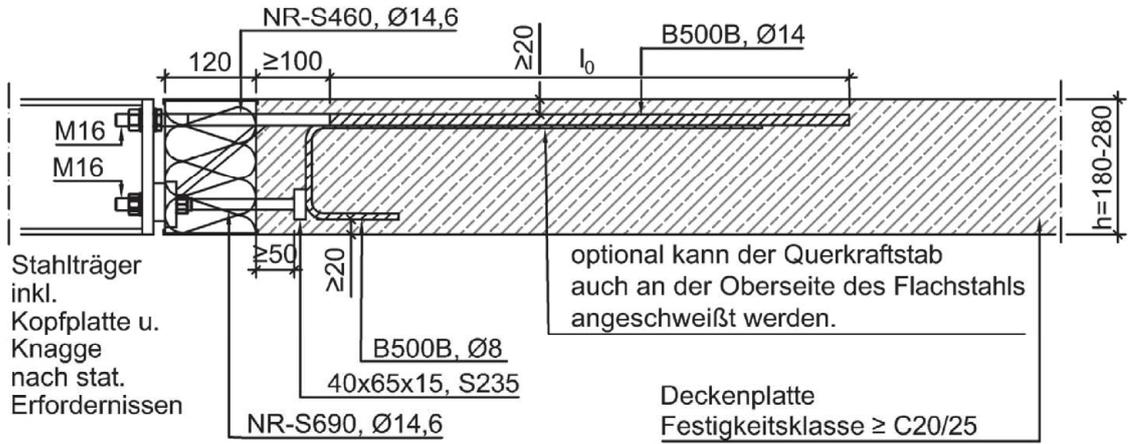
Abbildung 25: Seitenansicht IP 120 SM14 Q8 und IP 120 SM14 Q10
