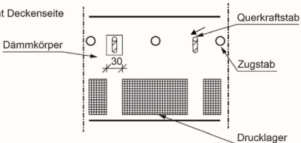
Plattenanschluss ULTIPTRO UP und UPQ zum Anschluss von Stahlbetonplatten
