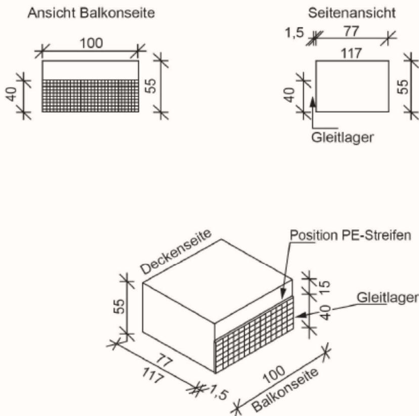
Dämmkörper mit Drucklager
