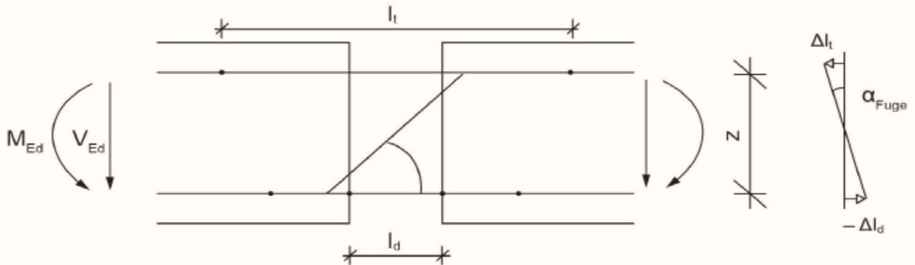
Drehwinkel in der Fuge:  $\tan \alpha_{\text{Fuge}} = \frac{\Delta l_t - \Delta l_d}{Z}$
