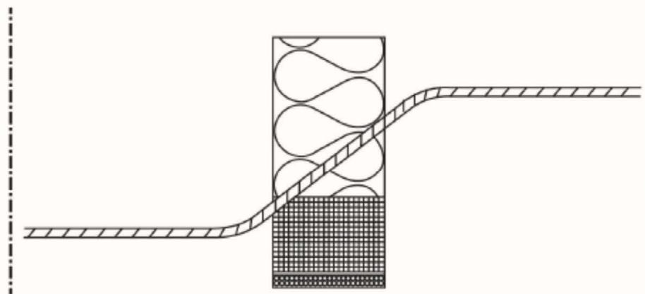
Plattenanschluss ULTIPRO UP und UPQ zum Anschluss von Stahlbetonplatten
