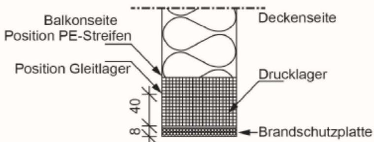
Plattenanschluss ULTIPTRO UP und UPQ zum Anschluss von Stahlbetonplatten
