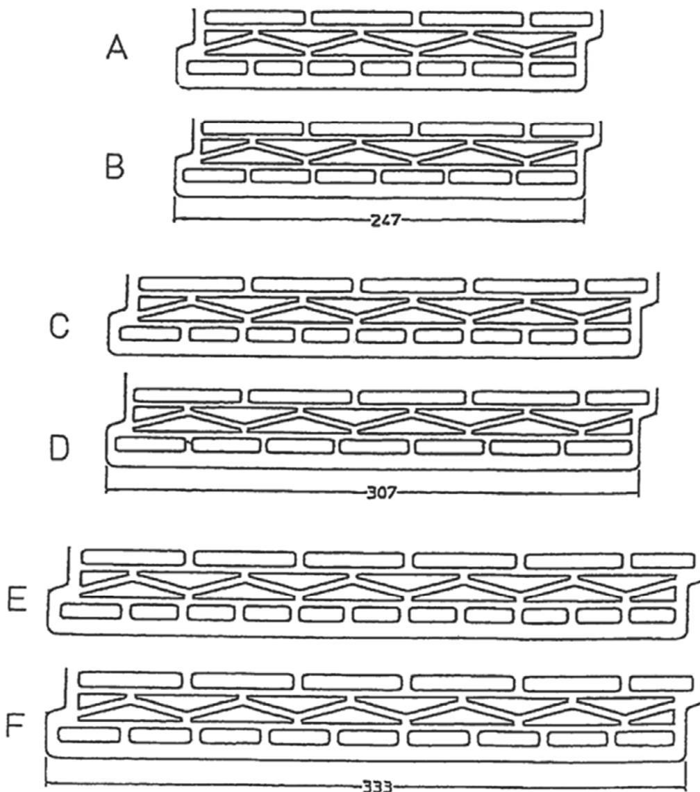
Mauerwerk aus Planhochlochziegeln - bezeichnet als "Hörl+Hartmann Klimatherm ST plus
