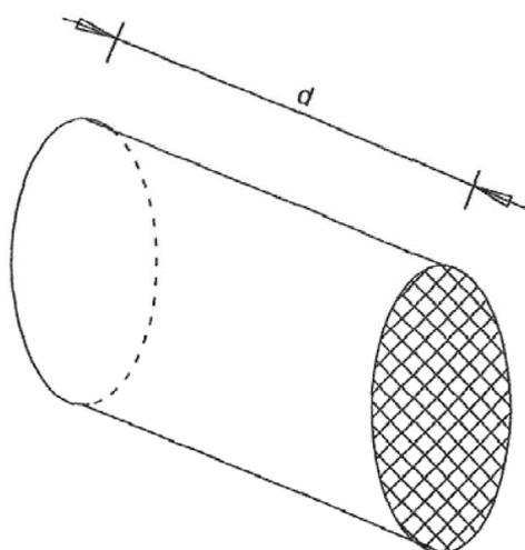
$$D_{\text{Stopfen}} = \frac{D_{\text{Kernbohrung}}}{0,85}$$
