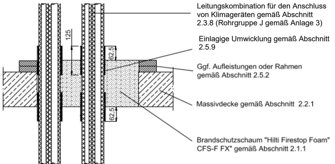
Feuerwiderstandsfähige Abschottung für elektrische Leitungen und/oder Rohrleitungen aus Kunststoff oder Metall "System CFS-F FX 200"
