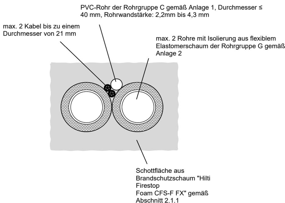
Feuerwiderstandsfähige Abschottung für elektrische Leitungen und/oder Rohrleitungen aus Kunststoff oder Metall "System CFS-F FX 200"
