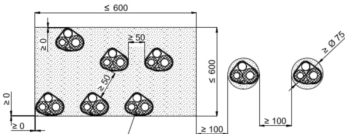
Leitungskombination für den Anschluss von Klimageräten gemäß Abschnitt 2.3.8 (Rohrgruppe J gemäß Anlage 3)
