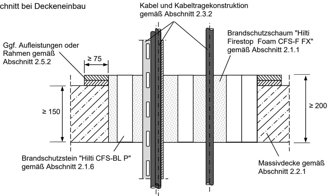
Feuerwiderstandsfähige Abschottung für elektrische Leitungen und/oder Rohrleitungen aus Kunststoff oder Metall "System CFS-F FX 200"
