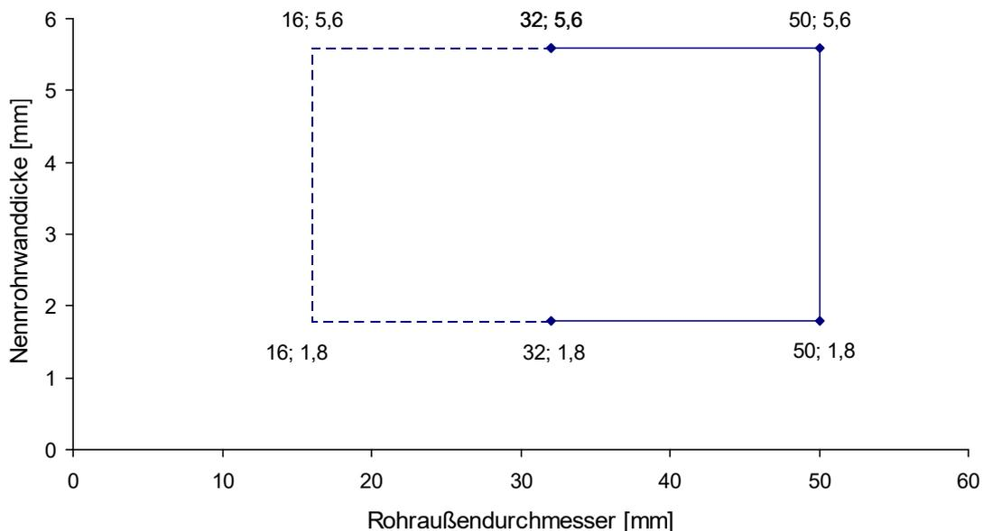
**Rohre der Rohrgruppe D gemäß Anlage 1\***
