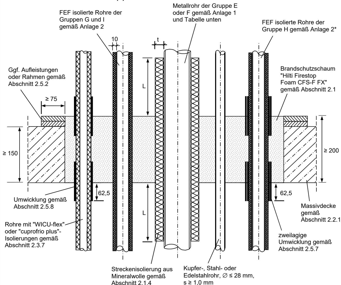
Streckenisolierungen als Brandschutzmaßnahme an nicht isolierten Metallrohren
