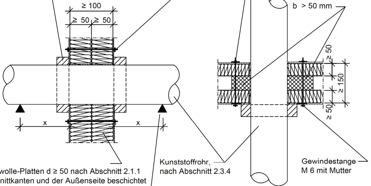
Mineralwolle-Platten  $d \geq 50$  nach Abschnitt 2.1.1 auf Schnittkanten und der Außenseite beschichtet dämmschichtbildender Beschichtung nach Abschnitt 2.1.3.1, Trockenschichtdicke  $d \geq 1$  mm
