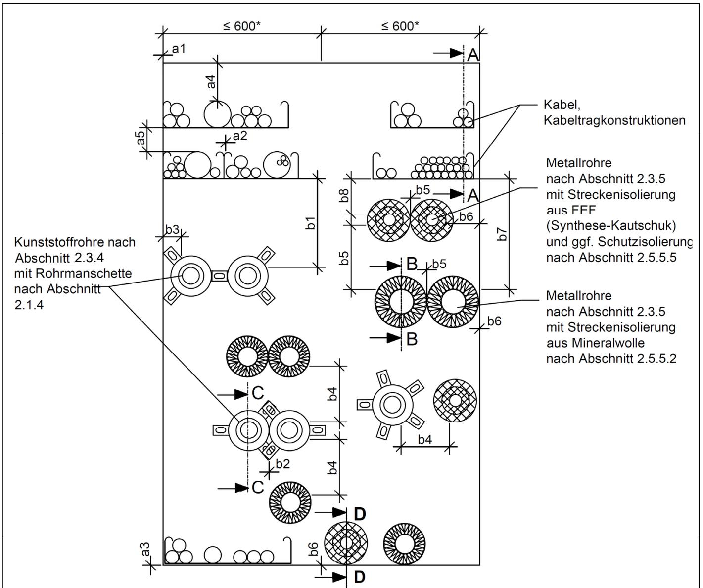
Maximale Abmessungen der Abschottung:
