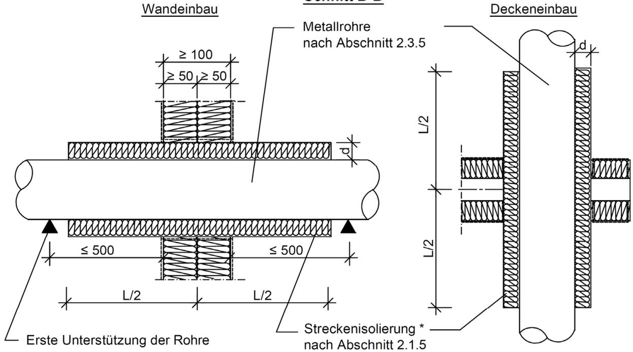
\* Streckenisolierung darf wahlweise an die Schottoberfläche anschließen oder durch das Schott hindurchgeführt werden;
