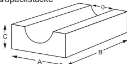
Packstücke sind Halbschalen mit einer Nut passend zum AD der abzudichtenden Leitung
