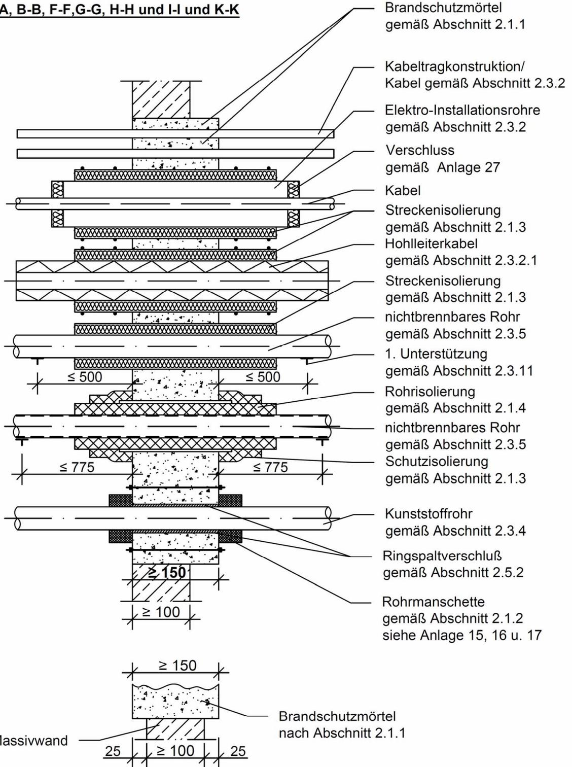
Feuerwiderstandsfähige Abschottung für elektrische Leitungen und/oder Rohrleitungen aus Metall oder Kunststoff "System PYROMIX"
