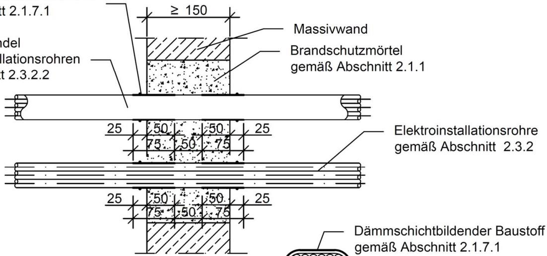
vorgefertigte Bündel aus Elektroinstallationsrohren gemäß Abschnitt 2.3.2.2
