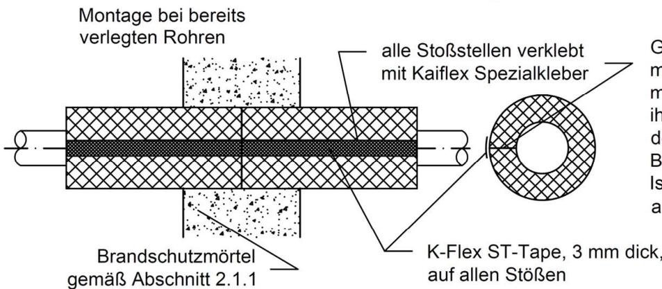
Geschlitzte Schläuche sind zusätzlich mit einem Draht,  $d > 1,4$  mm, mit 8 Umwicklungen je lfd. Meter in ihrer Lage zu sichern. Der Abstand der ersten Umwicklung zur Bauteiloberfläche bzw. zum Isolierungsende muss  $a \leq 50$  mm sein
