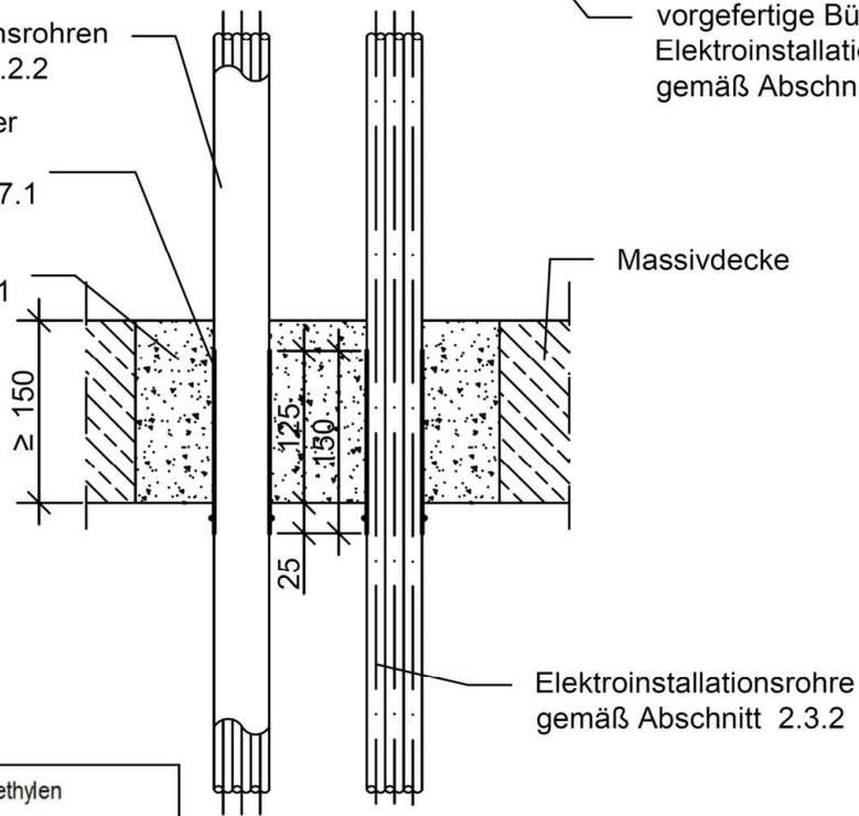
Elektroinstallationsrohre gemäß Abschnitt 2.3.2
