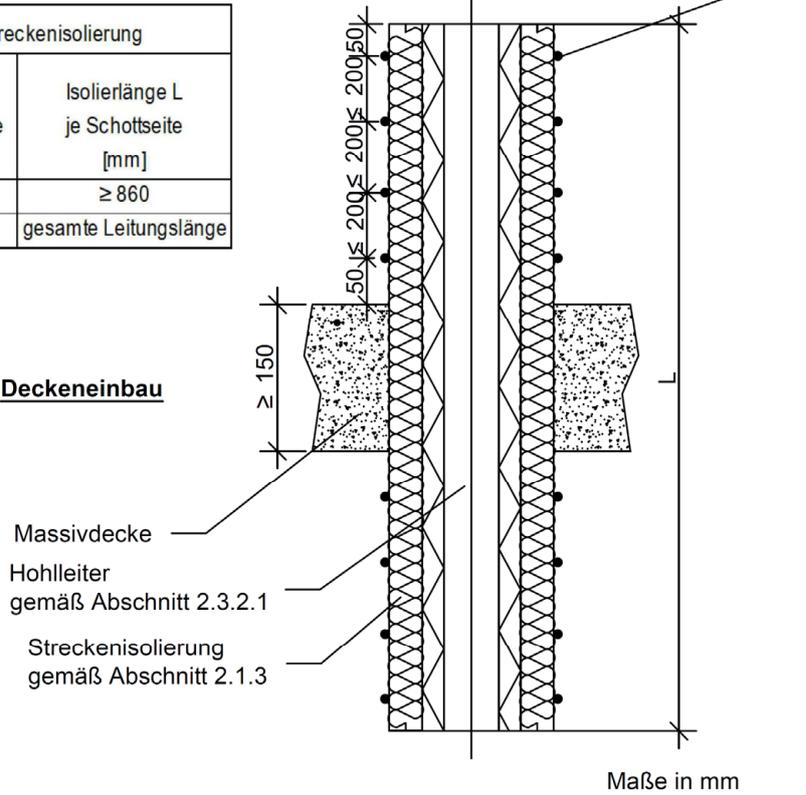
Feuerwiderstandsfähige Abschottung für elektrische Leitungen und/oder Rohrleitungen aus Metall oder Kunststoff "System PYROMIX"
