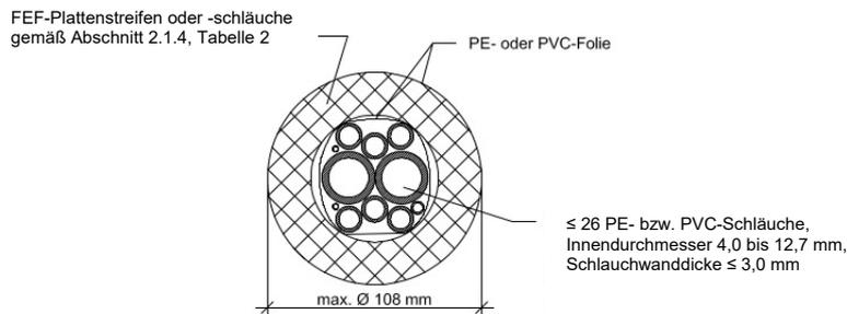
Feuerwiderstandsfähige Abschottung für elektrische Leitungen und/oder Rohrleitungen aus Metall oder Kunststoff "System PYROMIX"
