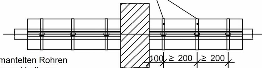
Abstand zwischen den ummantelten Rohren und zwischen Ummantelung und Laibung, bei Wand- und Deckeneinbau ≥ 0 mm
