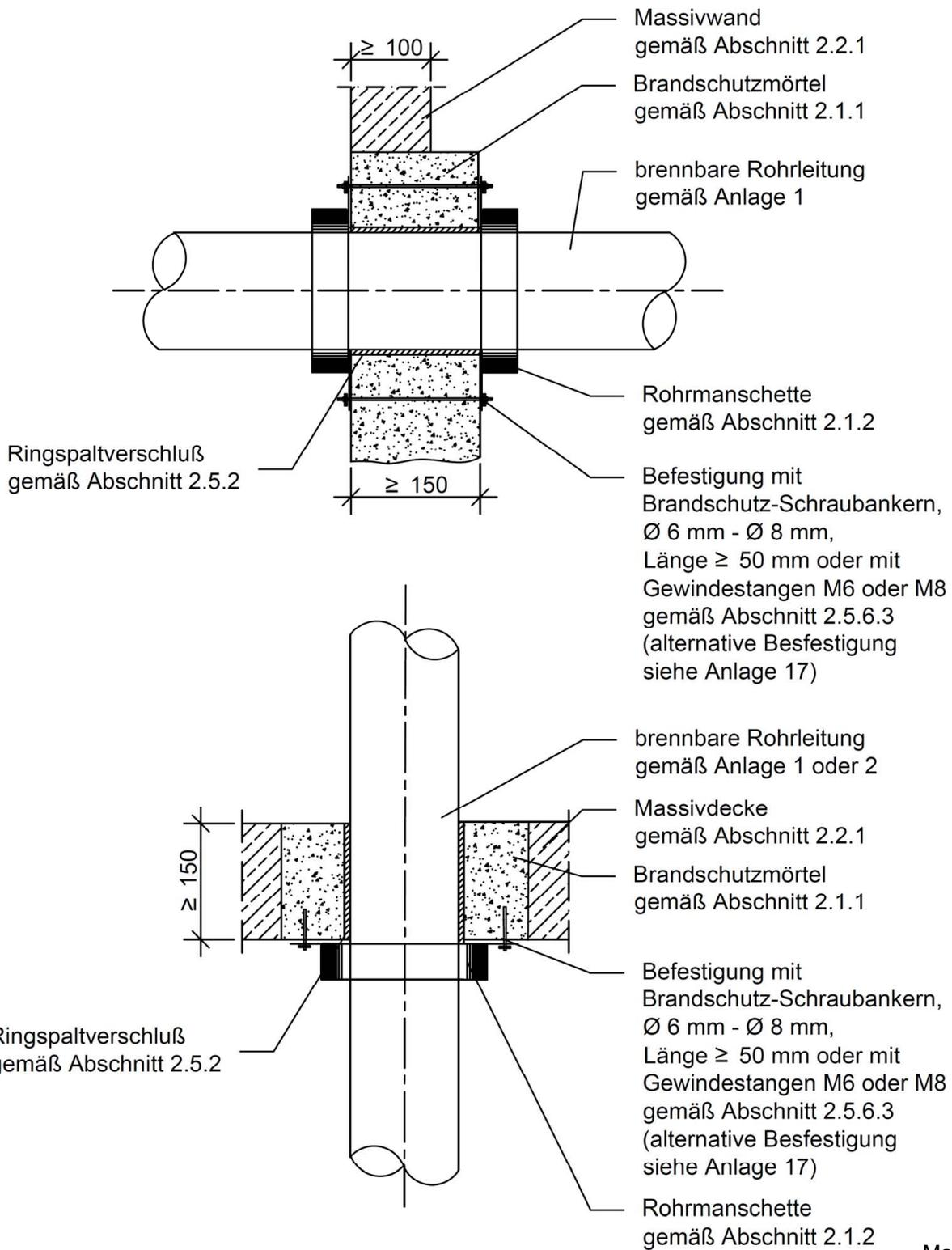
Feuerwiderstandsfähige Abschottung für elektrische Leitungen und/oder Rohrleitungen aus Metall oder Kunststoff "System PYROMIX"
