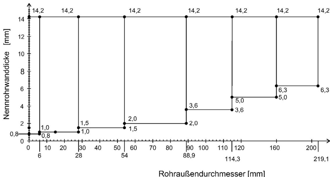
**Zulässige Rohre aus Kupfer mit Streckenisolierungen aus Elastomerschaum (FEF) bei Isolierlänge je Seite von  $\geq 750$  mm; Isolierdicken s. Anlage 15**
