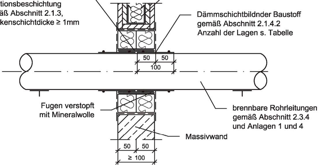
Mineralwolleplatten  $d \geq 50$  mm gemäß Abschnitt 2.1.1, außenseitig beschichtet mit Ablationsbeschichtung gemäß Abschnitt 2.1.3, Trockenschichtdicke  $\geq 1$  mm
