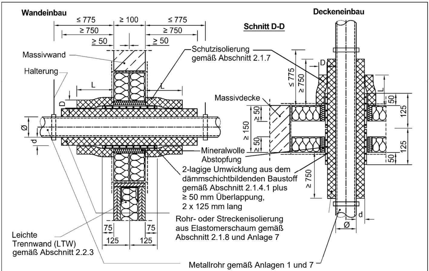
Streckenisolierungen dargestellt; das Rohr darf aber auch durchgehend isoliert sein
