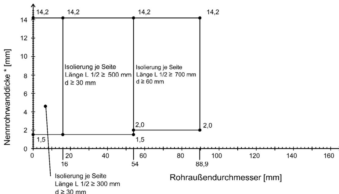
Für die Rohr- oder Streckenisolierungen sind Mineralwolle-Matten oder Mineralwolle-Schalen gemäß Abschnitt 2.1.7 zu verwenden (s. Anlage 14).
