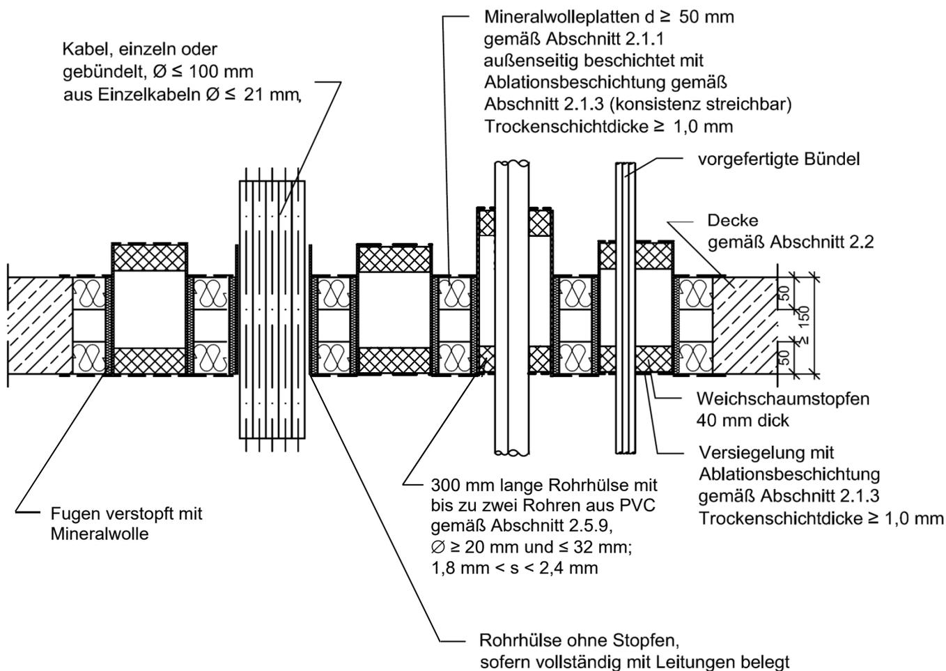
Feuerwiderstandsfähige Abschottung für elektrische Leitungen und/oder Rohrleitungen aus Metall oder Kunststoff "System PYROPLATE Fibre"
