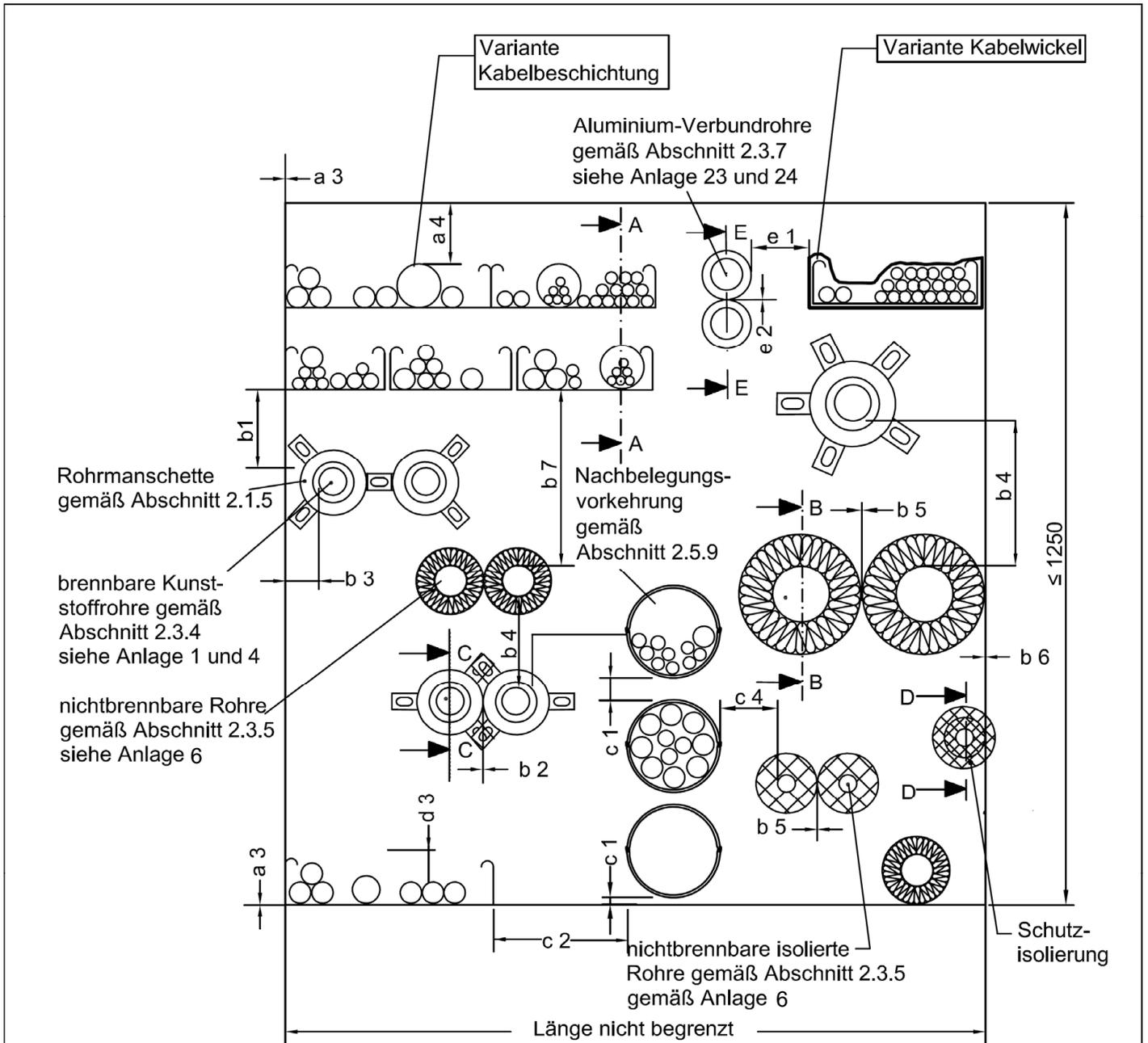
**Maximale Abmessungen der Abschottung:**
