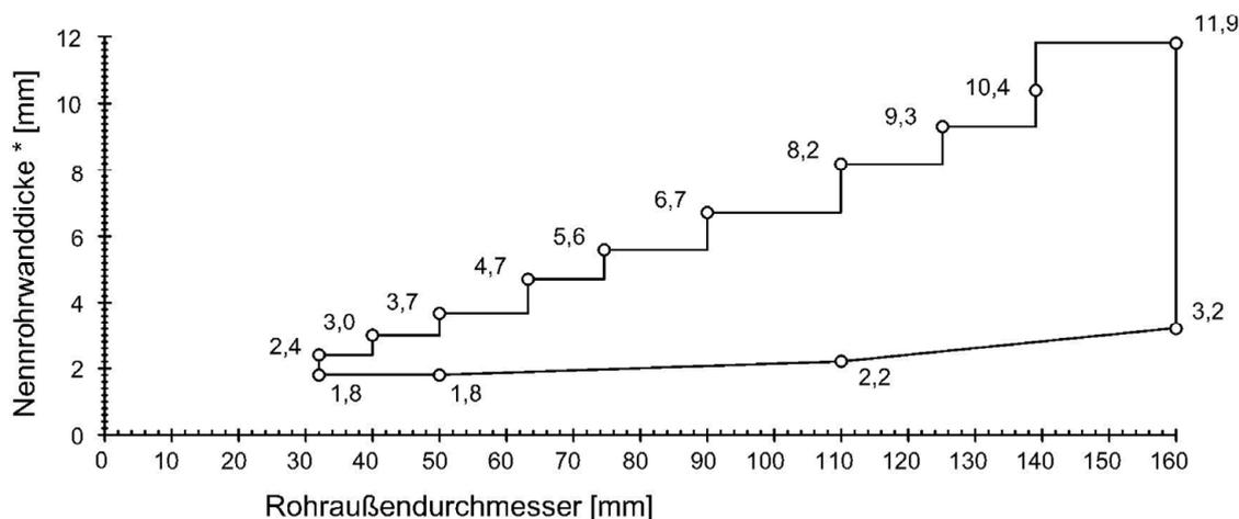
Rohre gemäß Rohrgruppe B der Anlage 1
