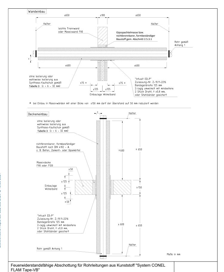
ANHANG 2 – Aufbau der Abschottung Errichtung in Wänden und Decken
