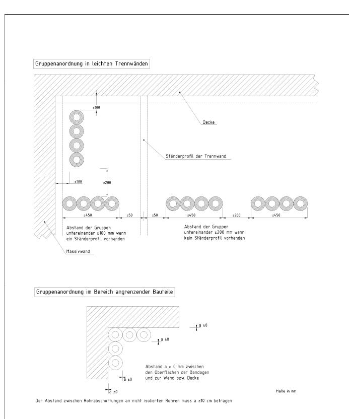
Feuerwiderstandsfähige Abschottung für Rohrleitungen aus Kunststoff "System CONEL FLAM Tape-VB"
