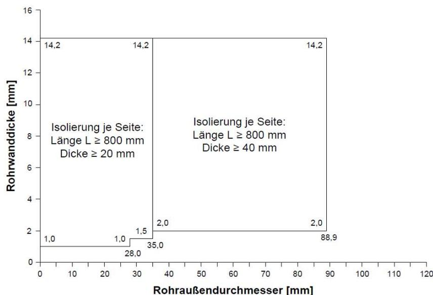
Für die Rohrisolierung sind nichtbrennbare Mineralwolle-Matten oder Mineralwolle-Schalen gem. Abschnitt 2.1.5 zu verwenden, deren Schmelzpunkt  $\geq 1000\text{ °C}$  liegt. Die Nennrohrdichte muss mindestens  $90\text{ kg/m}^3$  betragen.
