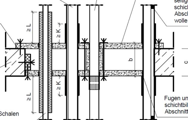
Feuerwiderstandsfähige Abschottung für elektrische Leitungen und/oder Rohrleitungen aus Metall oder Kunststoff "ZZ M23-S90"
