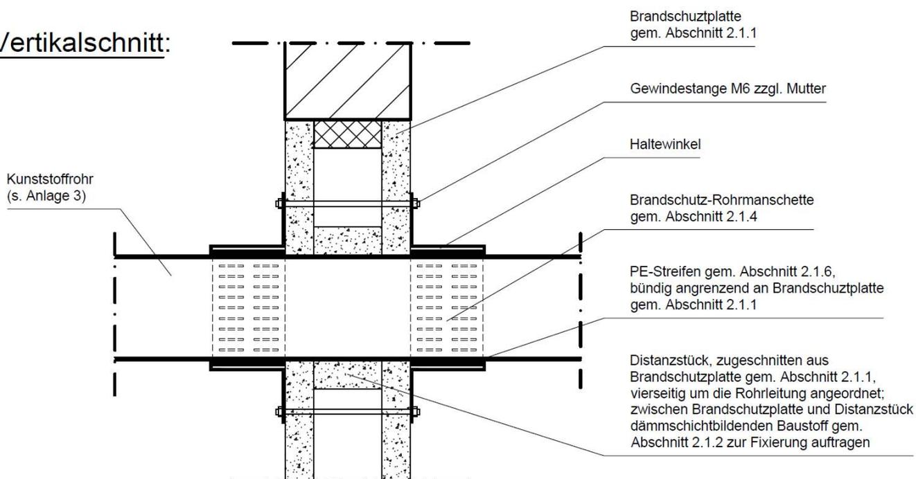
Feuerwiderstandsfähige Abschottung für elektrische Leitungen und/oder Rohrleitungen
