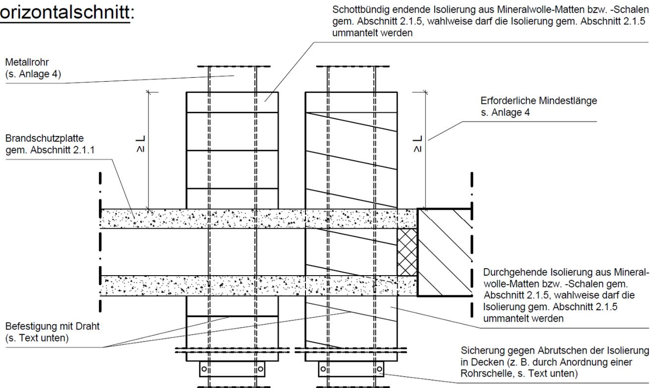
Die Rohrisolierungen sind mit mindestens 0,6 mm dicken Draht mit 6 Wicklungen pro lfd. Meter zu befestigen und dürfen wahlweise durch die Abschottung hindurchgeführt werden oder an der Schottoberfläche enden. In Decken ist die Isolierung gegen Abrutschen zu sichern (z. B. durch eine auf dem Rohr montierte Rohrschelle).
