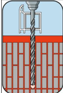
Fensterrahmen ausrichten und fixieren. Bohrloch in den Verankerungsgrund durch das Fensterprofil hindurch erstellen (siehe Anlage 9). Das Bohrverfahren ist der Anlage 21 - Anlage 154 zu entnehmen.
