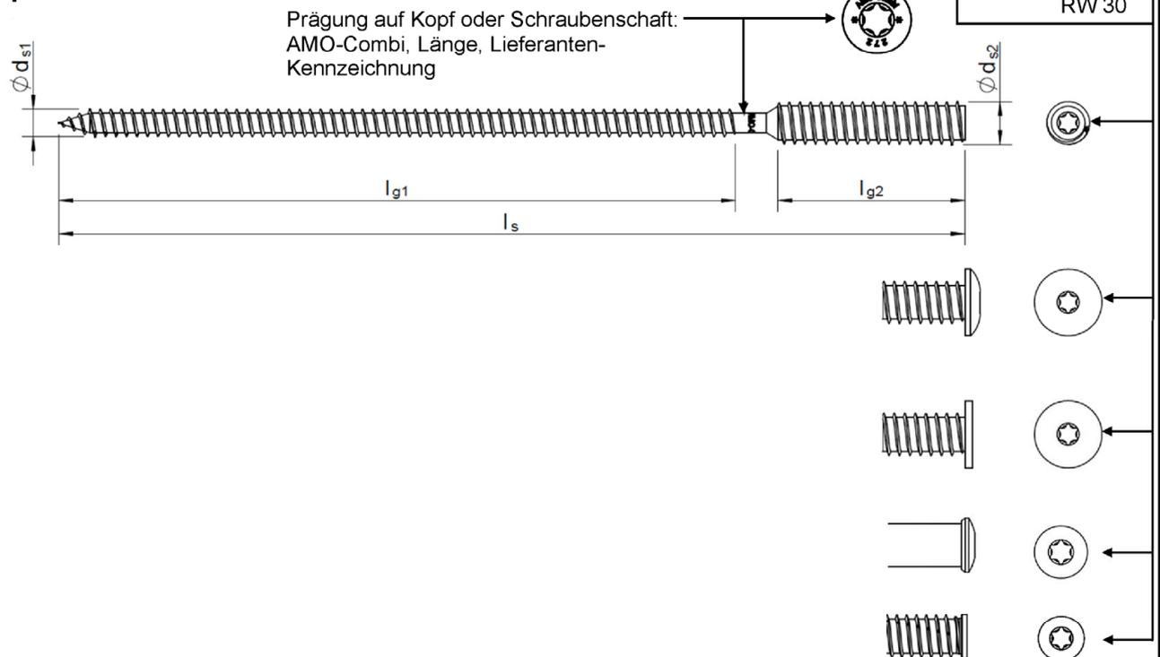
Würth AMO®-Combi Schraube mit Kunststoff-Dübelhülse W-UR 10 XS und W-UR 10 XXL zur Befestigung von Fensterrahmen in Mauerwerk
