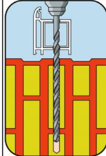
Fensterrahmen ausrichten und fixieren. Bohrloch in den Verankerungsgrund durch das Fensterprofil hindurch erstellen (siehe Anlage 9). Das Bohrloch ist im Drehgang zu erstellen.
