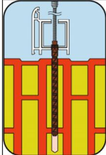
Der vormontierte Dübel muss durch das Fensterprofil mit einem Handhammer unter leichtem Klopfen bis zur Setztiefenmarkierung in das Bohrloch im Verankerungsgrund gesetzt werden.
