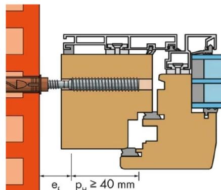
Würth AMO®-Combi Schraube mit Kunststoff-Dübelhülse W-UR 10 XS und W-UR 10 XXL zur Befestigung von Fensterrahmen in Mauerwerk
